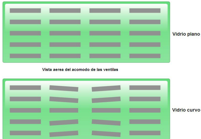
Figura 5.16 Posición de las ventilas en el Quench y conveyor.
