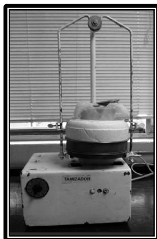
Figura 12. Agitador de tamices con acoplamiento para la prueba de distribución del tamaño de partícula de las mezclas.
