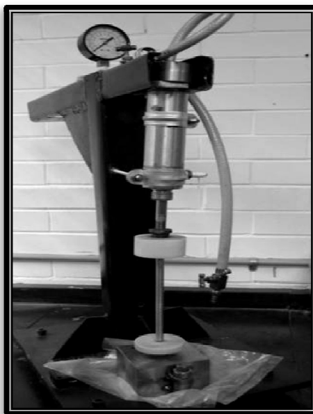
Figura 16. Máquina de compactación para el desarrollo de compactados de café soluble.
