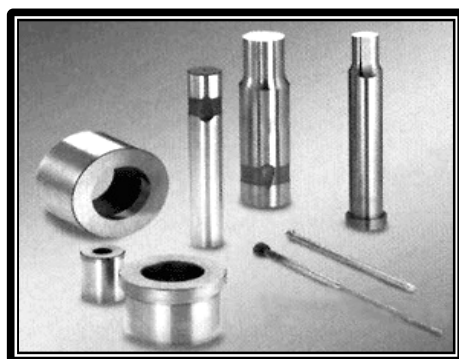
Figura 5. Punzones inferior, superior y matriz como unidades mecánicas básicas para la compresión de compactados (Remington, 2003).
