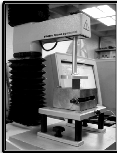
Figura 14 d. Prueba de compactación.
