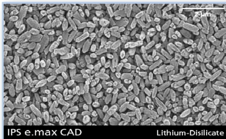
Fig. 17 Microscopia de barrido electrónica del sistema IPS e.max CAD®.
