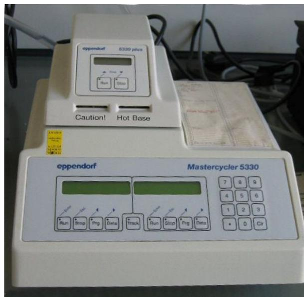
**Figura 18.** Máquina que mide la reacción en cadena de la polimerasa. <sup>8</sup>
