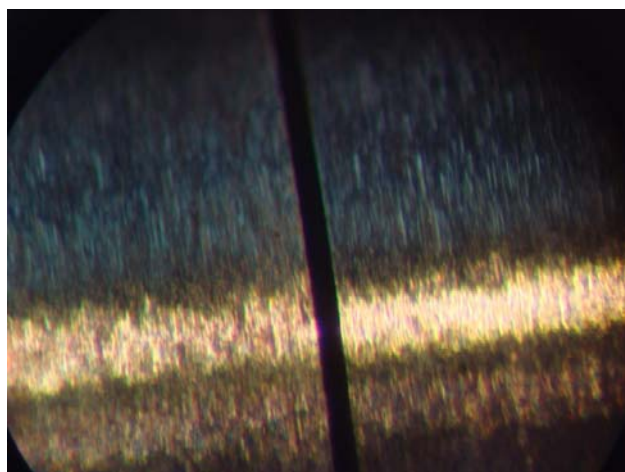
Fig 22/23. Calibrador digital/ Fotografía de referencia de una línea de 100 micrómetros de ancho aumentada 70X en el microscopio de medición MGC-10.
