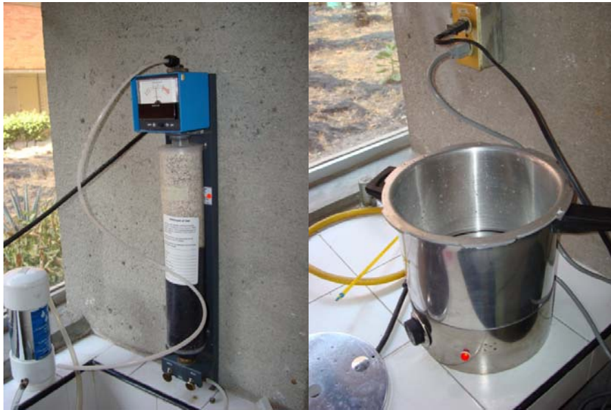
Fig.24/25. Filtro de agua desionizada/Calentamiento del agua desionizada a 110°C
