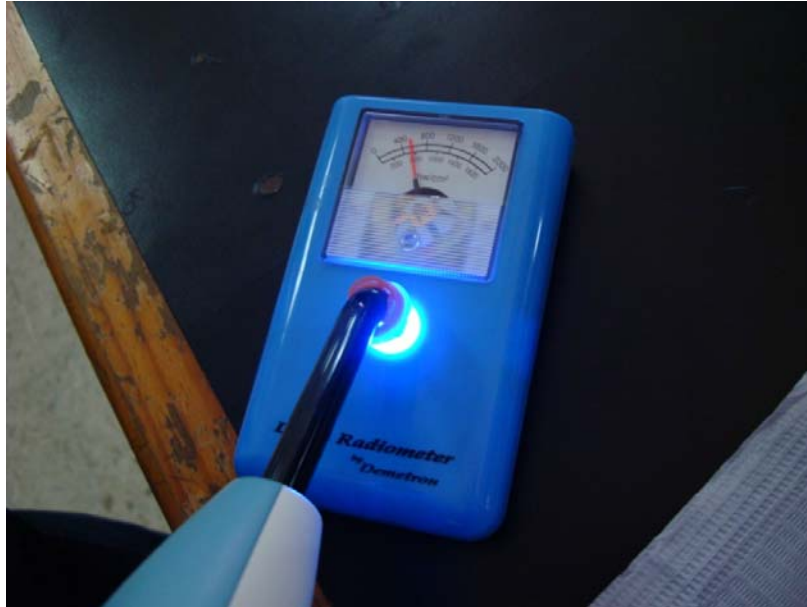
Fig11. Determinación de la potencia mediante un radiómetro.
