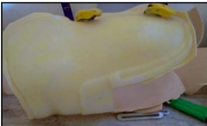
Pegado de una nueva capa de pelite con pegamento de pegamento Resistol 3080.
