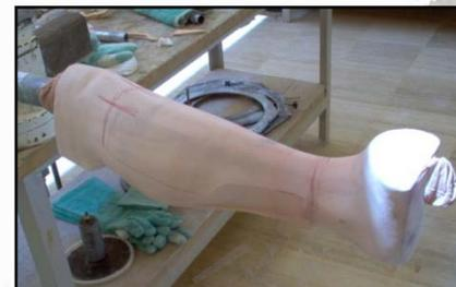
Imagen del molde ya modificado y listo para aplicarle la lámina de polipropileno.
