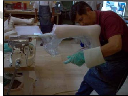
Una vez con el polipropileno en estado plástico, es decir transparente, el siguiente paso tiene que ser muy rápido y con muchísima precisión, para no tener o que repetirlo y desperdiciar material, que es: con un par
