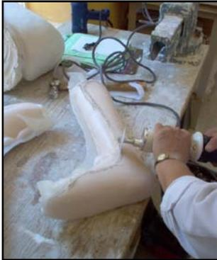
Una vez que el molde se enfrió con la lámina termoformada de polipropileno y con la pieza de la órtesis marcada por la parte de abajo del material plástico, sobre la media, procederemos al corte de la pieza con una sierra especial de disco, para así poder darle los acabados finales.
