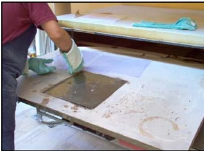
Por otro lado se marcan los trozos de polipropileno, las cuales va a consistir la férula y se cortan en una cizalla, para meterlas al horno, en el cual se van a dejar hasta que el material este transparente, aproximadamente unos 180°
