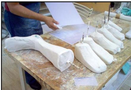
Después de cortar la placa de polipropileno, tomando la medida de la punta del molde a la parte más alta (contando la curva) se prepara para el horno.
