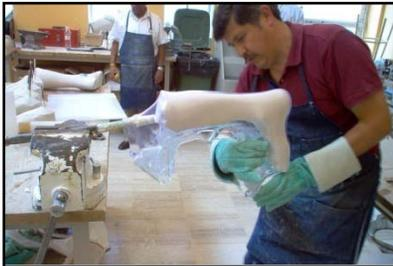
Primera plastificación del molde, esto se hará por cada una de las piezas, de ser posible, se busca que salgan dos por segmento de lámina, y así agilizar la fabricación y economizar material.
