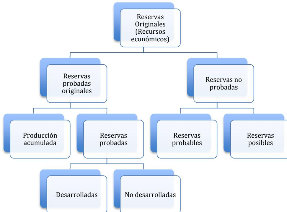
Ilustración 2- Clasificación de Reservas Fuente: Estimación de Reservas de Hidrocarburos, SENER, 2010.
