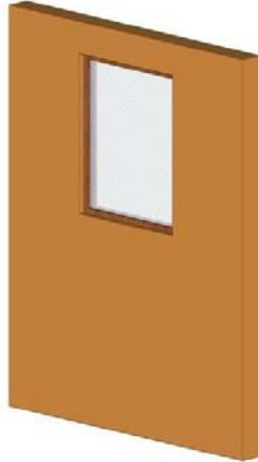
Fig. No. 31 Geometría de ventana rectangular vertical de 0.80x1.0m
