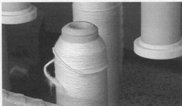
Figura 20. Conos de hilo de algodón obtenido del estirado.
