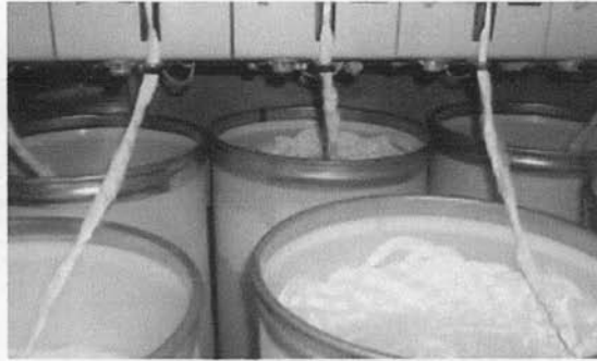
Figura 18. Fibras torcidas resultantes del peinado.
