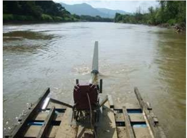
Fotografía 2-2. Rotor parcialmente fuera del agua. Hidrored (2003).
