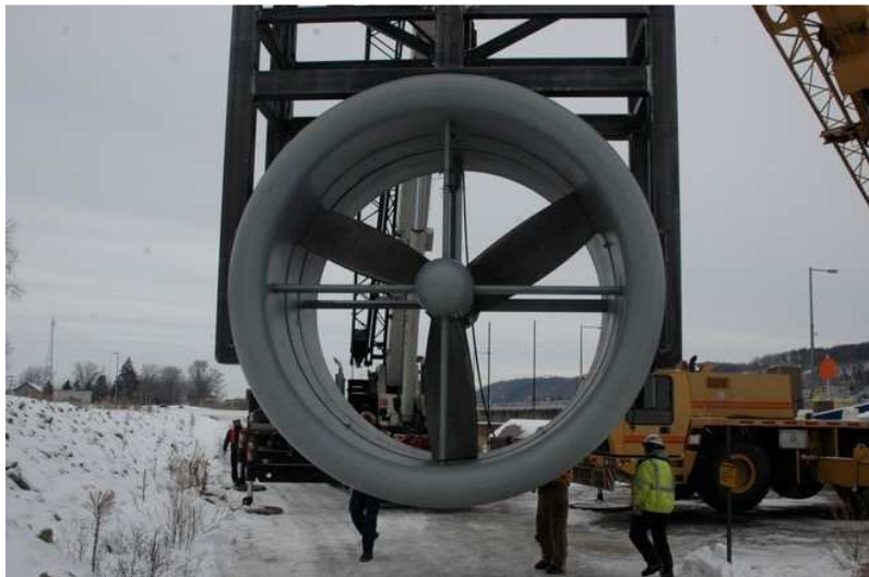
Fotografía 2-3. Turbina hidrocínética comercial, potencia 35 KW, río Mississippi, E.U.A.
