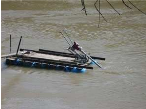
Fotografía 2-1. Turbina hidrocinética en prueba. Rio Cauca (Cali). Hidrored (2003).
