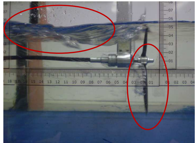
Fotografía 5-2. Inclusión de aire al fluido producido por la THC en estado semi ahogado.
