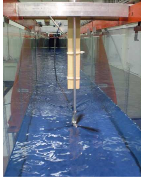
Fotografía 4-6. Toma de mediciones del tirante.
