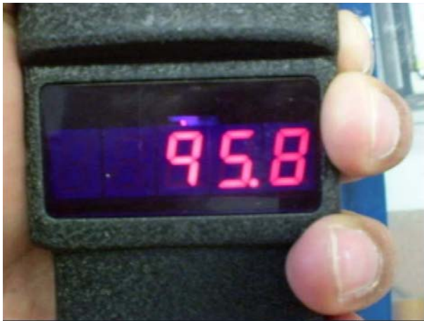
Fotografía 4-7. Toma de lecturas con tacómetro.
