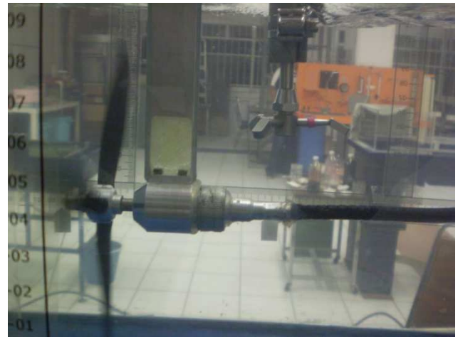
Fotografía 4-4. Toma de lecturas de velocidad con equipo ADV.
