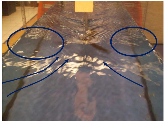
Fotografía 5-7. Zona de alentamiento de la velocidad del agua y tendencia de las líneas de corriente a la entrada de la THC.
