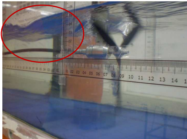
Fotografía 5-1. Generación de oscilaciones en la superficie libre de canal, dirección aguas abajo de la THC.
