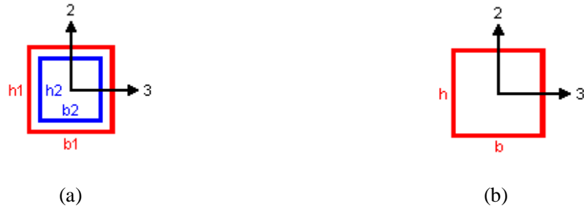
Figura 3.4: (a) módulo de creación de perfiles para PTR (b) módulo de creación de perfiles para placa
