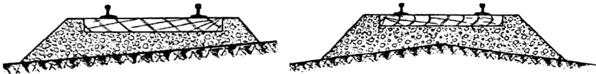
Figura 2.6 Plataforma a una y dos aguas.
