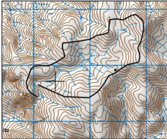
Figura 2.2 Configuración de una cuenca hidrográfica en un mapa topográfico, el rasgo en línea continua es el parteaguas.
