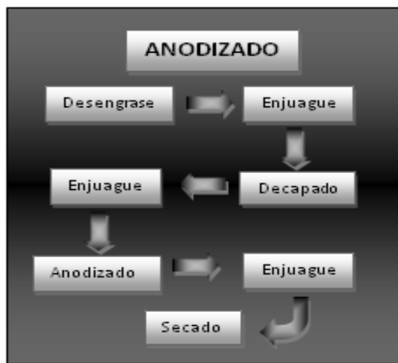
Figura 2.2 Proceso de anodizado. [23]
