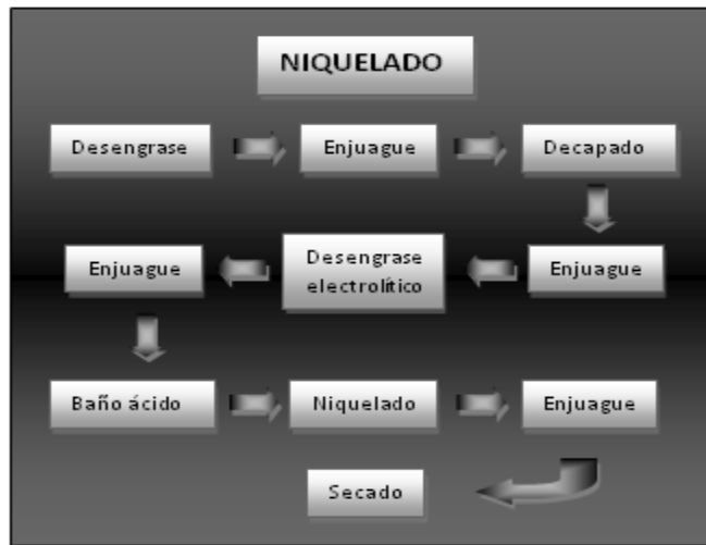
Figura 2.3 Proceso de Niquelado. [20]
