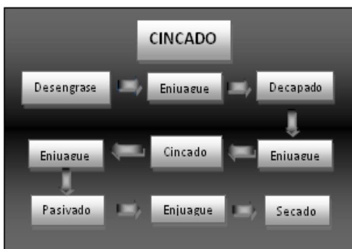
Figura 2.5 Proceso de Cincado. [20]
