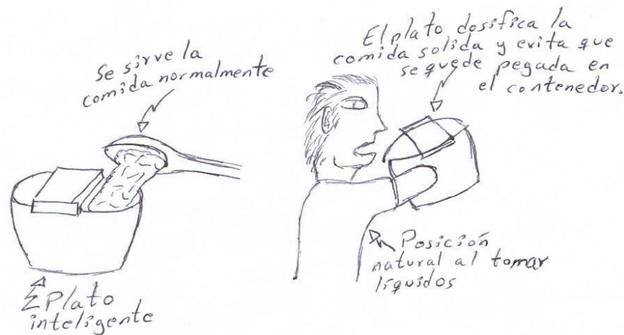
Figura 3.5 Boceto del funcionamiento del plato inteligente.
