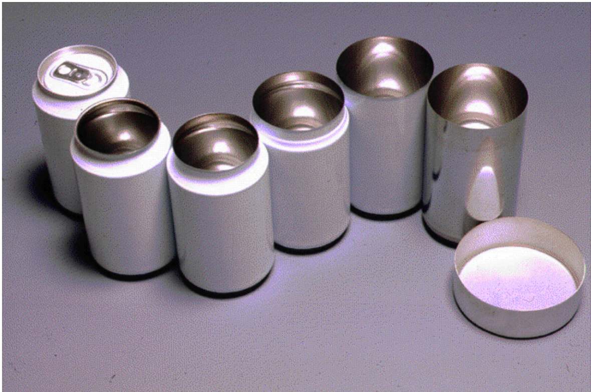
Figura 9. Proceso de fabricación de una lata.
