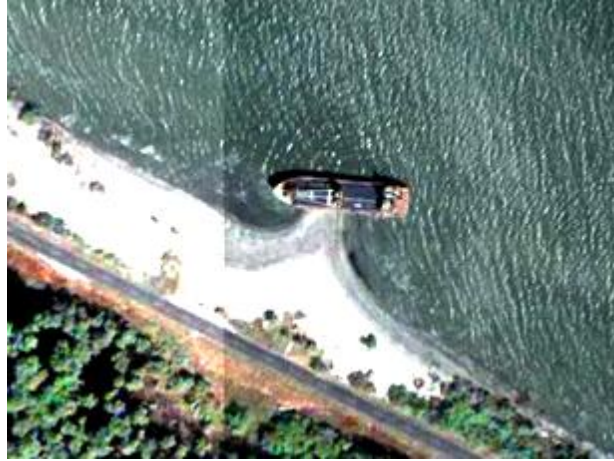
Figura 30. Barco encallado en la playa El Zacatal formando un tómbolo de arena por la sombra energética que produce en el oleaje.
