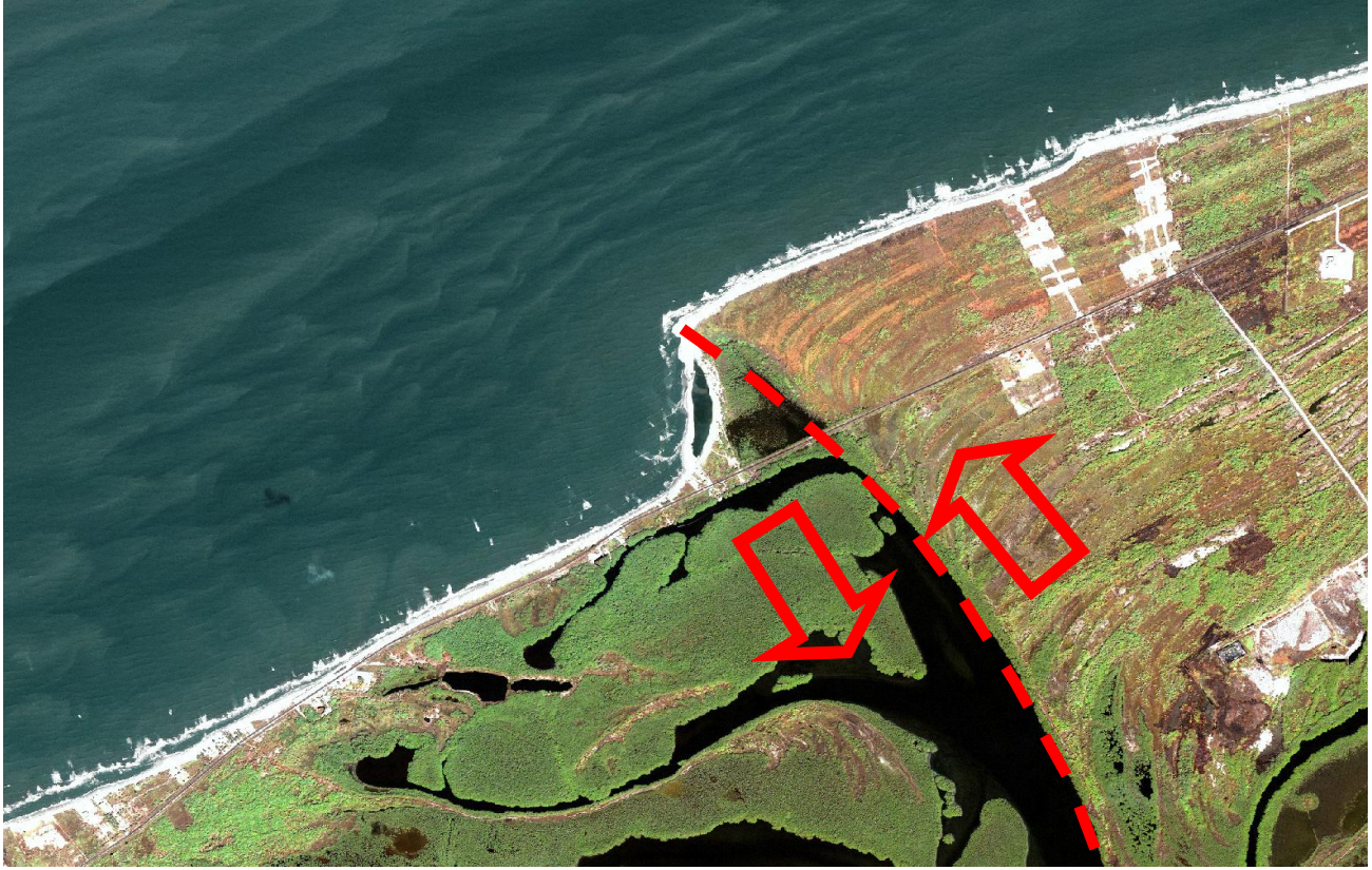
Figura 146. Posible falla con subsidencia en la Punta Brigitte Bardot en la Isla del Carmen. Camp.
