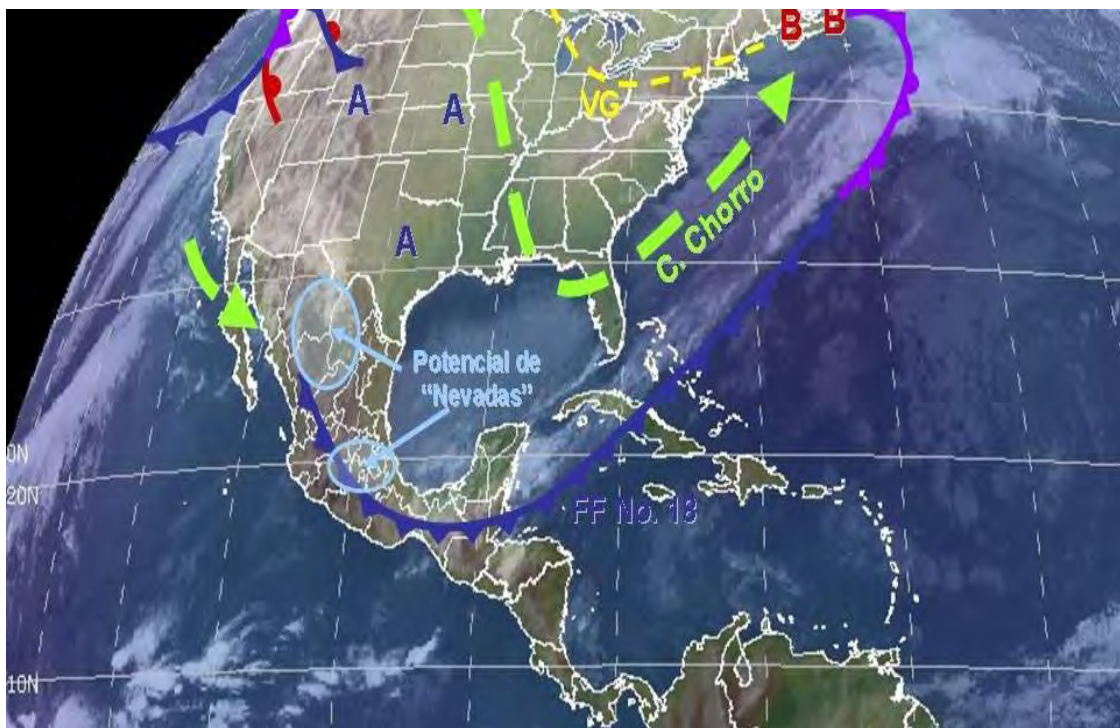
Figura 1.9 Imagen de satélite con la simbología de los diferentes sistemas de tiempo como las altas y bajas presiones representadas por la letra A y B , el frente frío FF , la Vaguada VG línea amarilla y la Corriente de Chorro , con línea verde. Fuente: SMN.
