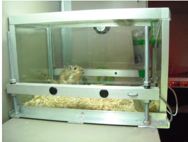
Figura 11. Fotografía que muestra el sistema de registro empleado para actividad locomotriz. Cada círculo negro de las barras metálicas en la parte lateral del contenedor de vidrio es un interruptor de sensor infrarrojo.
