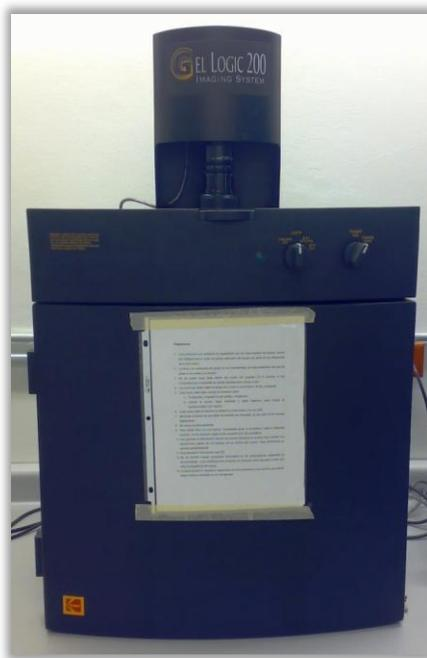
**Figura 4.10** Fotodocumentador Gel Logic 200, Imaging System (Kodak<sup>®</sup>), propiedad del Instituto de Ciencias Biomédicas UNAM, utilizado para obtener las imágenes de los productos amplificados por PCR.
