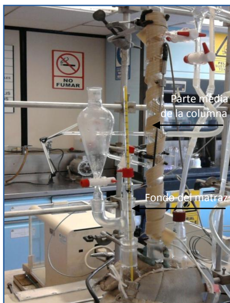
Figura 3.6 Monitoreo de la temperatura en la parte inferior del equipo, con un termómetro al fondo del matraz y un termopar a la mitad de la columna
