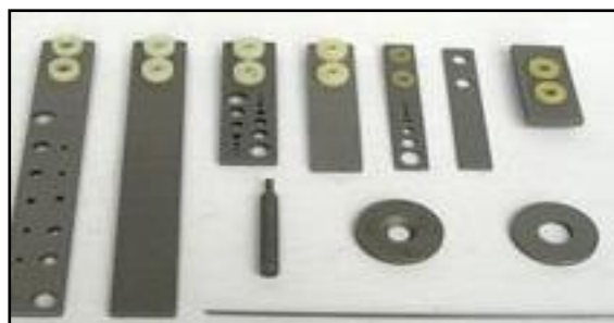
Figura 1.14 Cupones de Corrosión
