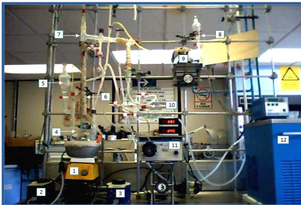
Figura 3. Equipo utilizado para cuantificar depósitos incrustantes de agentes neutralizantes. (1) Agitador Magnético, (2,3) Reóstato, (4) Matraz de bola con 3 bocas, (5) Embudo de adición de ácido clorhídrico, (6) Columna de destilación, (7) Línea de domo, (8) Embudo de adición del agente neutralizante, (9) Bomba de desplazamiento positivo, (10) Condensador, (11) Bomba peristáltica y (12) Recirculador.
