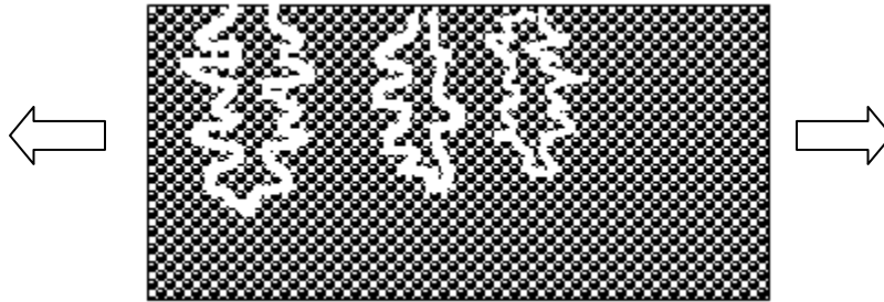
Figura 1.10 Corrosión por fatiga
