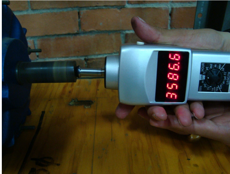
Figura 5.24.3 Motor alcanzando la frecuencia de 60 Hz y que en revoluciones corresponde a 3600 rpm
