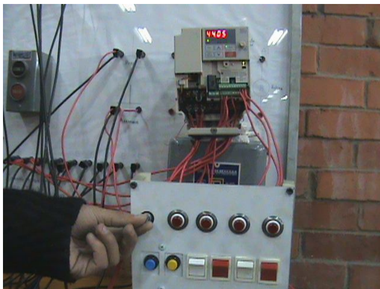
Figura 5.20.6 Frecuencia ajustada a 44.05 Hz mediante el potenciómetro.
