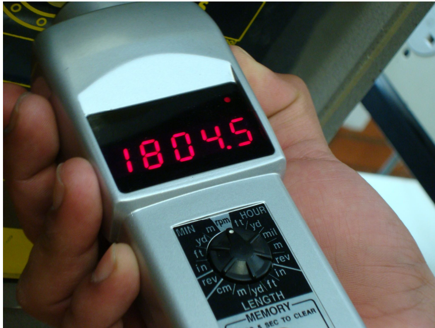
Fig. 5.18.6 Tacómetro digital mostrando la velocidad del motor a la frecuencia de 60 Hz.
