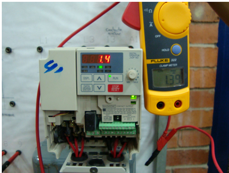
Figura 5.24.14 Corriente registrada al ponerse nuevamente en marcha al motor durante la desaceleración
