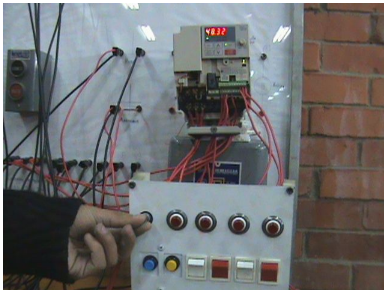
Figura 5.20.8 Frecuencia de referencia ajustada mediante el potenciómetro.
