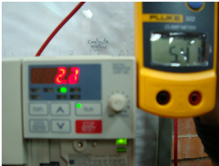
Figura 5.24.11 Segunda lectura de corriente consumida por el motor en la misma prueba
