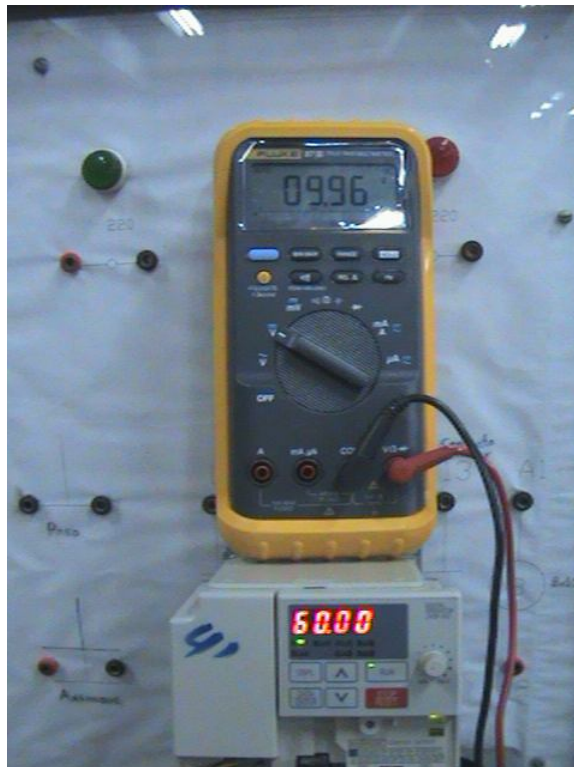
Fig. 5.20.2 Voltaje de salida del monitor analógico para 60 Hz.
