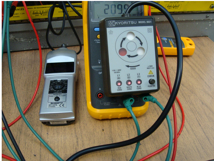
Fig. 5.10.7 Secuencímetro indicando el sentido hacia la izquierda
