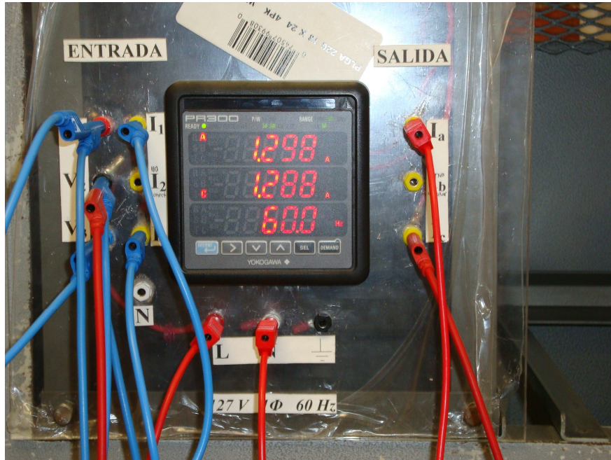
Fig. 5.5.5 Corriente del motor calculada por un medidor de energía YOKOGAWA
