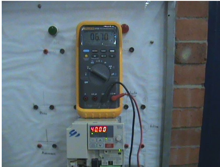
Fig. 5.20.3 Voltaje de salida del monitor analógico para 40 Hz.
