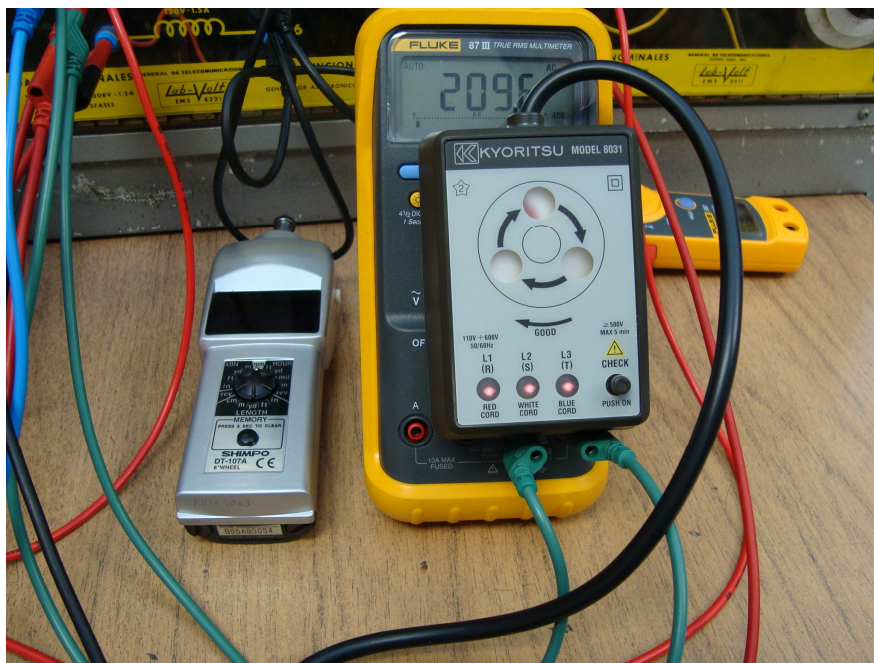
Fig. 5.10.9 Secuencímetro indicando el sentido hacia la izquierda
