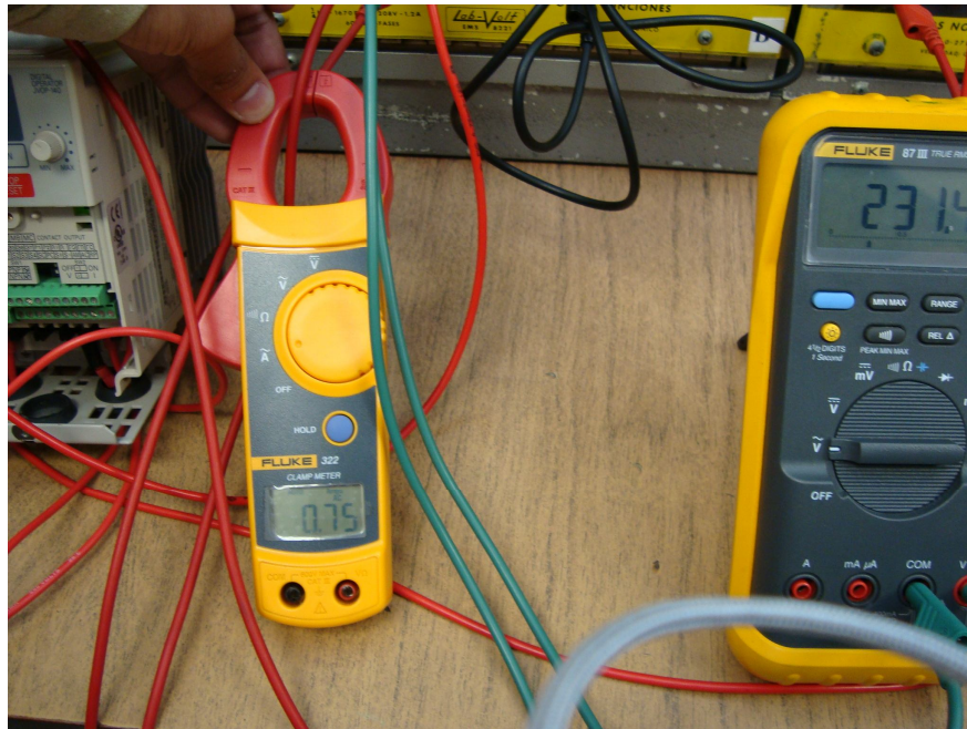
Fig. 5.10.13 Corriente medida con un amperímetro de gancho
