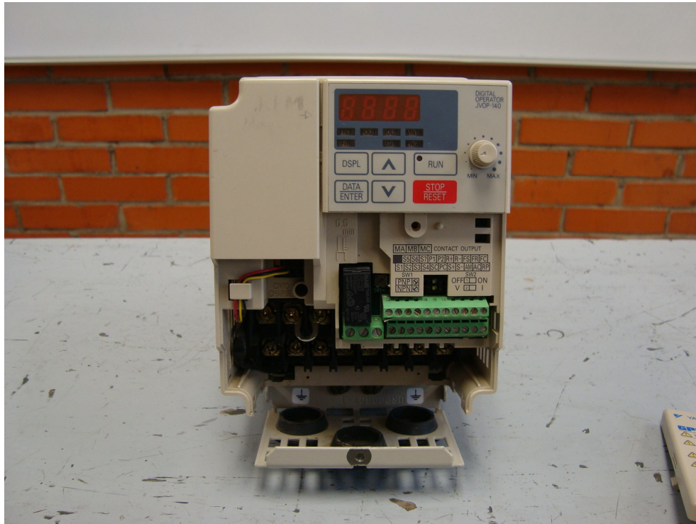
Fig. 3.1.2 Vista de las terminales del variador de velocidad YASKAWA
