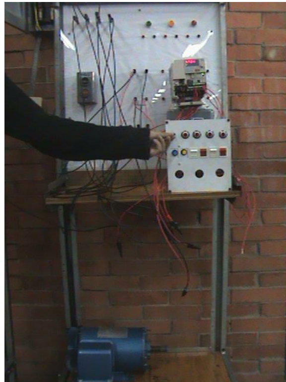
Figura 5.20.10 Disminuyendo la velocidad mediante el potenciómetro
