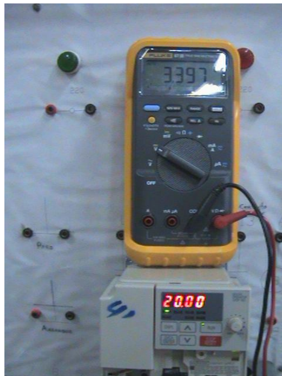
Fig. 5.20.4 Voltaje de salida del monitor analógico para 20 Hz.
