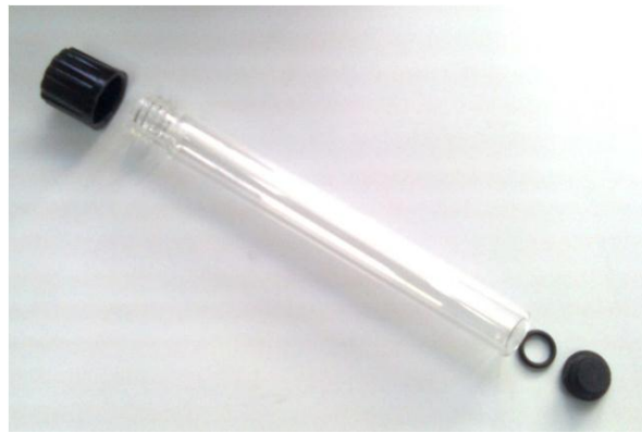
Figura 2.6. Tubos utilizados en el equipo Turbiscan MA 2000 para el estudio de la dispersión de luz por una muestra de crema batida.
