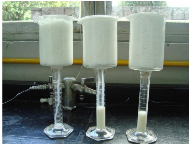
Figura 2.5. Copas de estabilidad para determinar el líquido drenado por las espumas a través del tiempo
