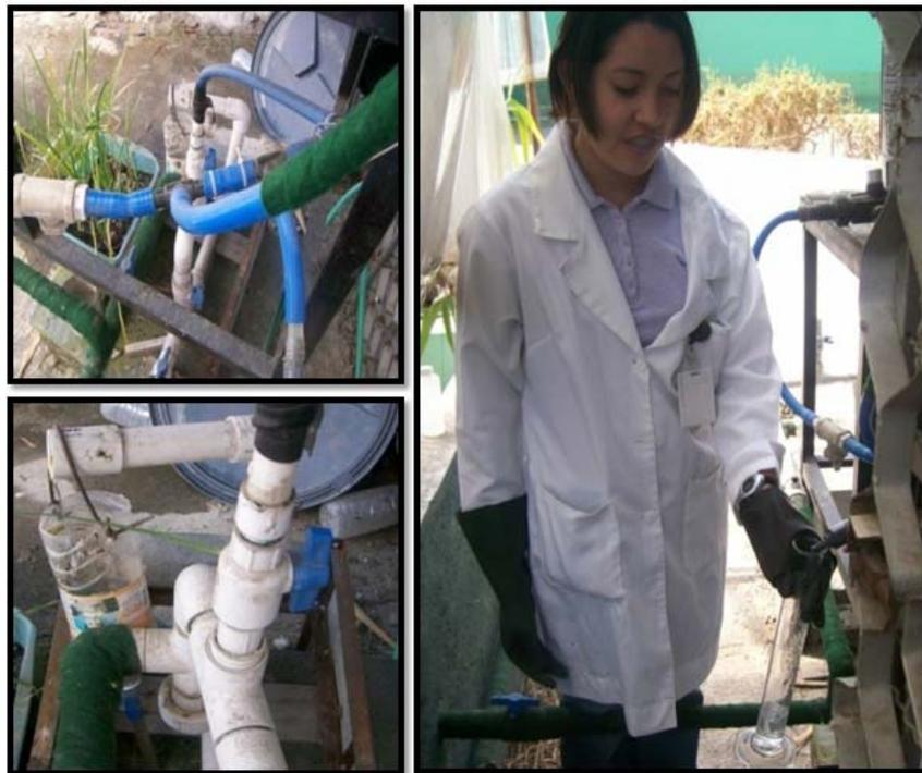
Figura 2.8 Medición del gasto de agua del influente y efluente
