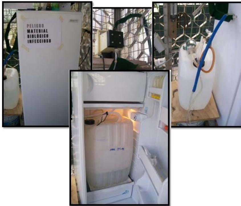
Figura 2.10 Arreglo experimental para controlar la temperatura de almacenamiento durante la alimentación de la orina humana al HAFSS
