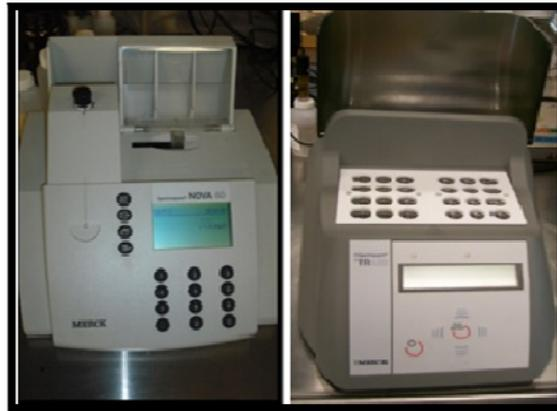
Figura 2.15 Fotómetro Spectroquant Nova 60 y Termoreactor Spectroquant TR 420
