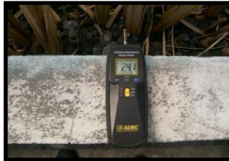
Figura 2.16 Higrómetro Thermo-hygrometer, Model CA846
