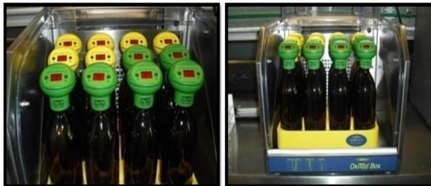
Figura 2.14 Sistema OxiTop para pruebas de  $DBO_5$
