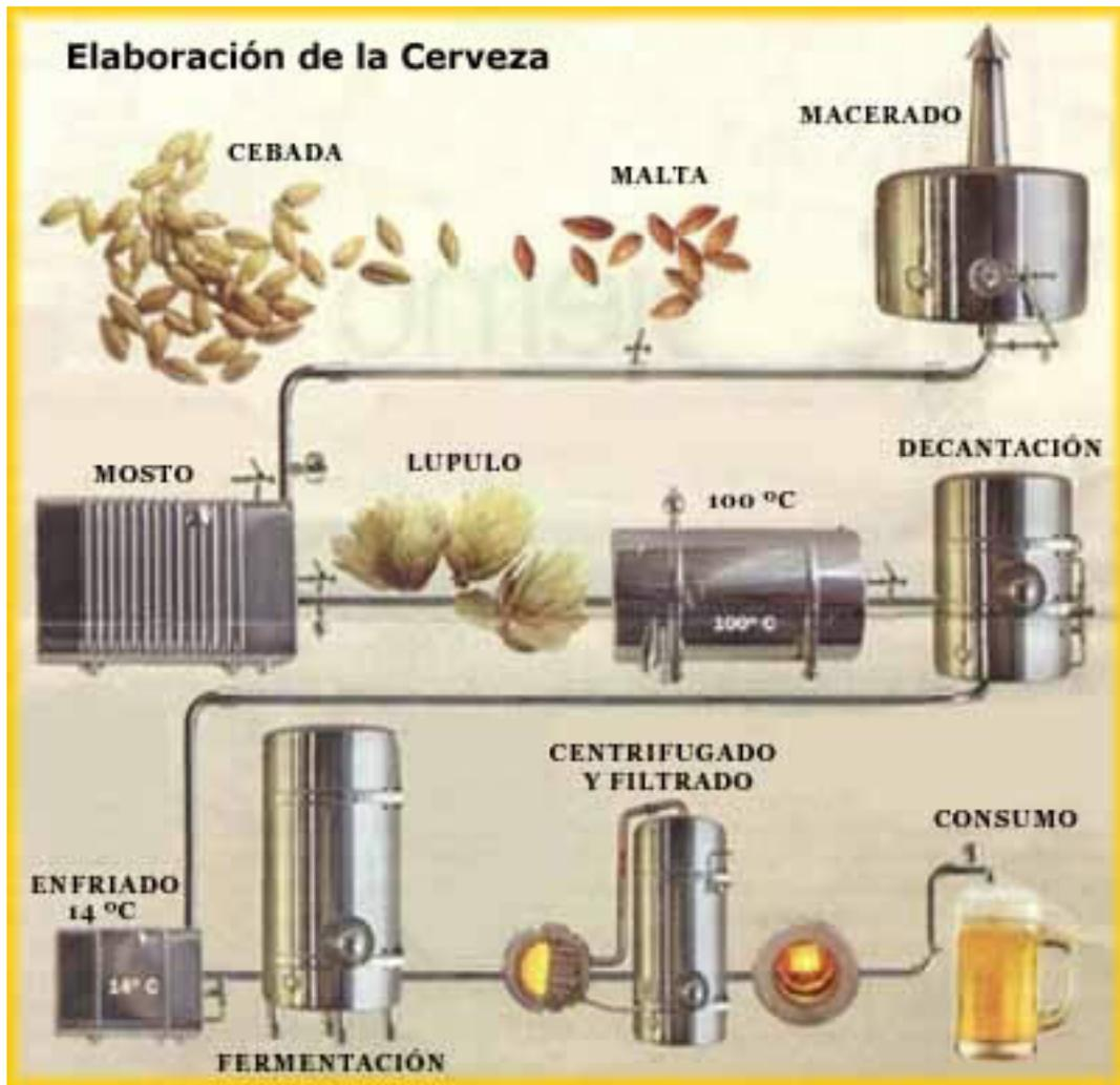
Figura 1. Proceso de fabricación de la cerveza[21]
