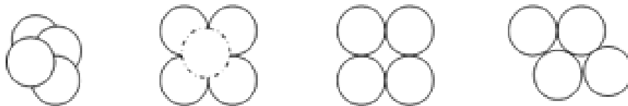
Figura 8. Diferentes formas de empaquetamiento de cuatro partículas de forma esférica. [7]
