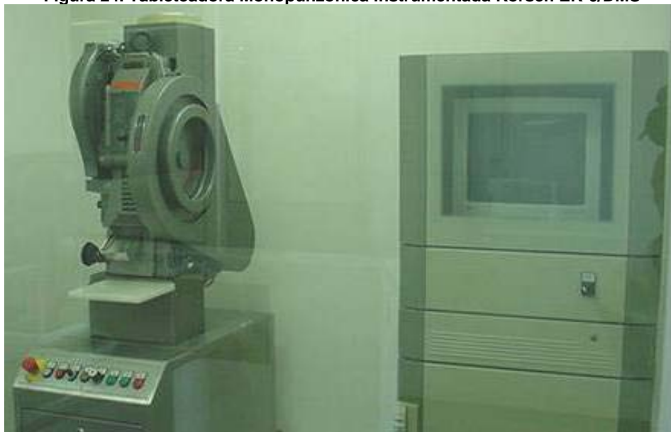
Figura 24. Tableteadora Monopunzónica Instrumentada Korsch EK-0/DMS
