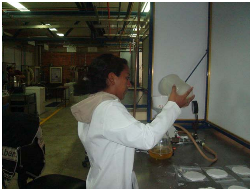
Figura 2.7 Filtración de nejayote con ayudafiltro en forma de precapa.
