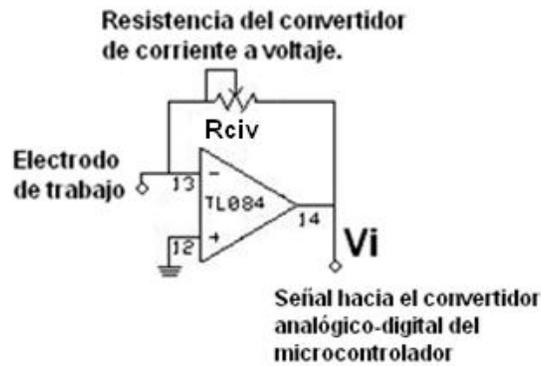
*Figura 2.17. Convertidor de corriente a voltaje.*
