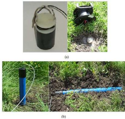
Figura 12. (a) Electrodo (EFP-06) de terreno de banda ancha, de tipo Pb/PbCl<sub>2</sub> y carrete.
