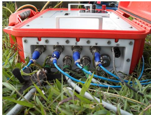
Figura 15. Conexiones para los sensores y bobinas.
