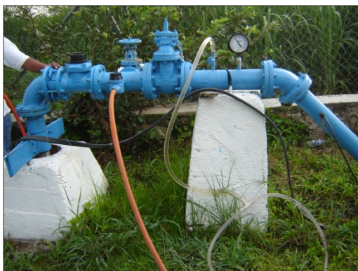
Fig. 5.2 Manguera adaptada a la válvula de descarga del pozo (a). Celda para medir parámetros físicos y recipiente de donde se tomarán las muestras (b).
