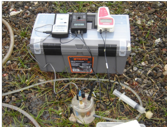
Fig. 5.3 Celda de aislamiento de flujo continuo para medición de parámetros de campo
