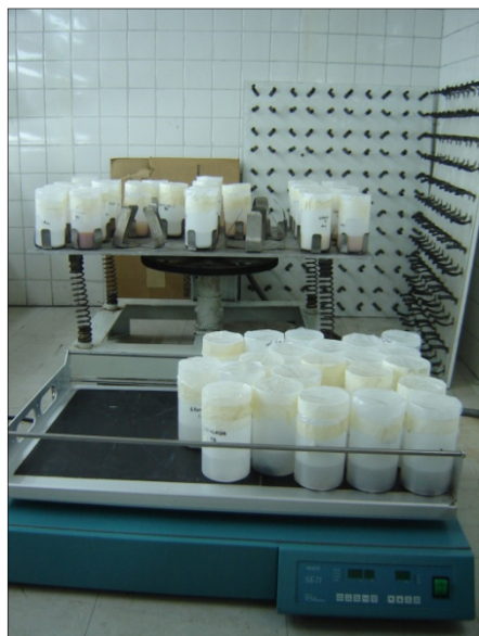
Fig.5.6 Experimento de interacción agua-roca, agitado diariamente por periodos de 20 minutos (a). Separación de agua-roca por filtración de dececación por vacío (b)
