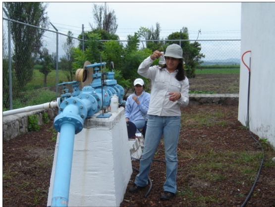
Fig. 5. 4. Procedimiento de titulación en el campo.
