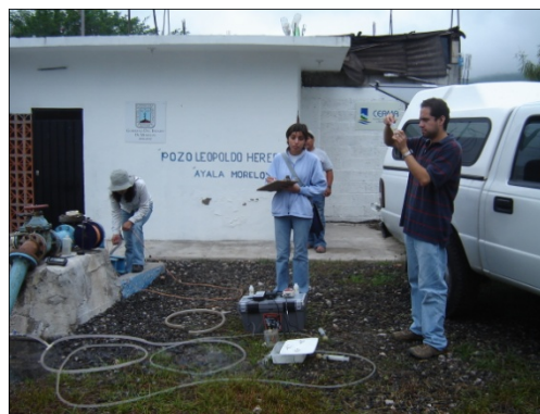
Fig. 5.2 Manguera adaptada a la válvula de descarga del pozo (a). Celda para medir parámetros físicos y recipiente de donde se tomarán las muestras (b).
