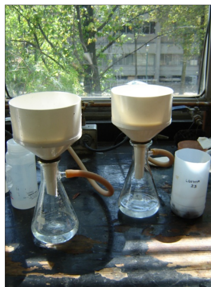
Fig.5.6 Experimento de interacción agua-roca, agitado diariamente por periodos de 20 minutos (a). Separación de agua-roca por filtración de dececación por vacío (b)
