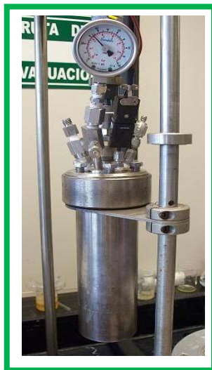
Fig. 26. Sistema de reacción para efectuar las reacciones de homopolimerización y copolimerización.
