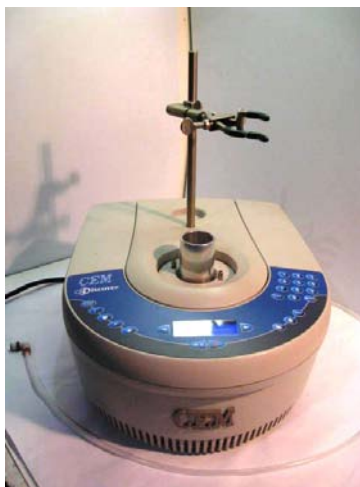
Fig. 35. Reactor de microondas CEM Discover, para síntesis de líquidos iónicos
