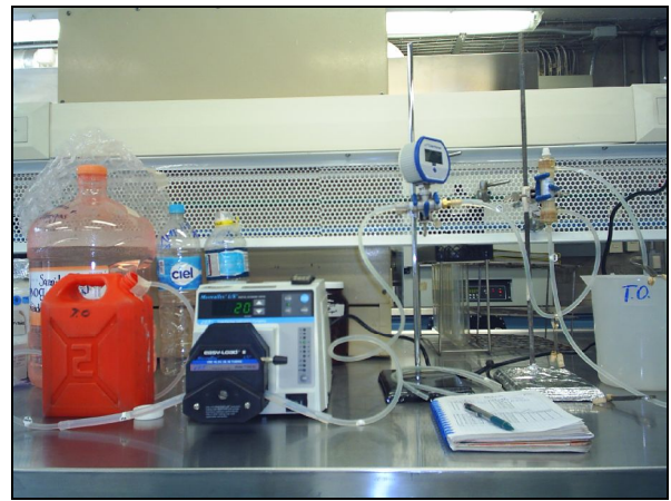
Fig. 3.15 Proceso de Microfiltración
