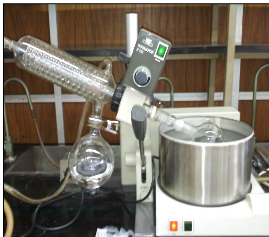
Fig. 3.6 Rotavapor durante la recuperación de Hexano
