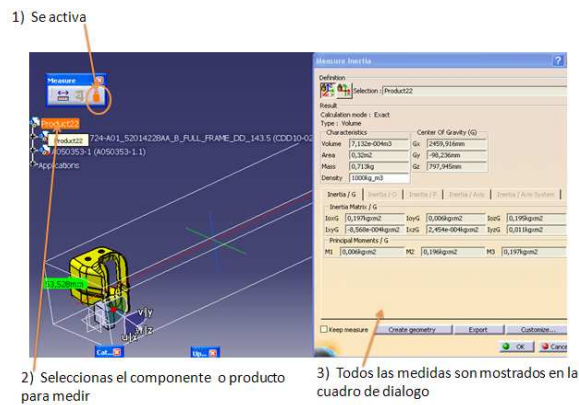
Figura 1.81. Pasos de la operación Medición de inercia.
