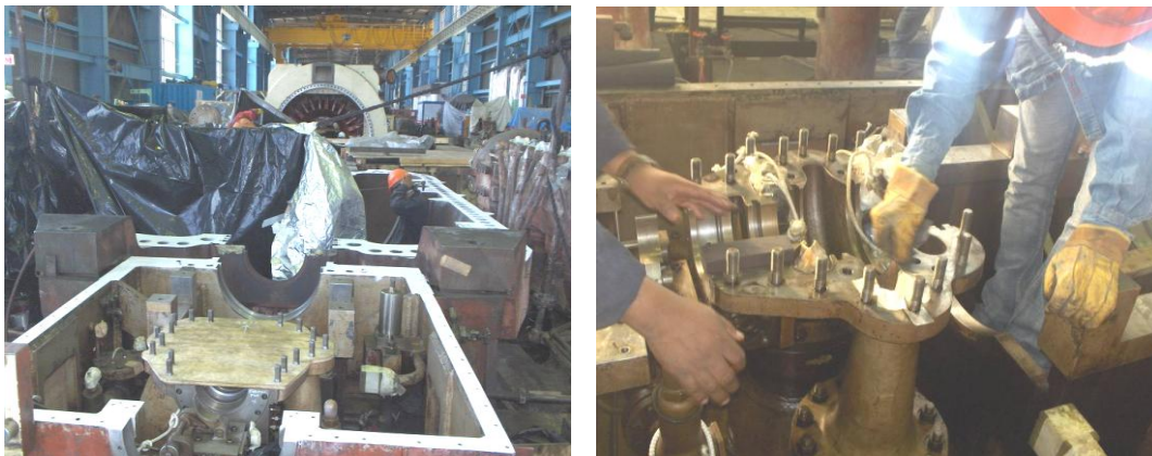
Figura 3.11. Pruebas no destructivas, líquidos penetrantes a junta horizontal
