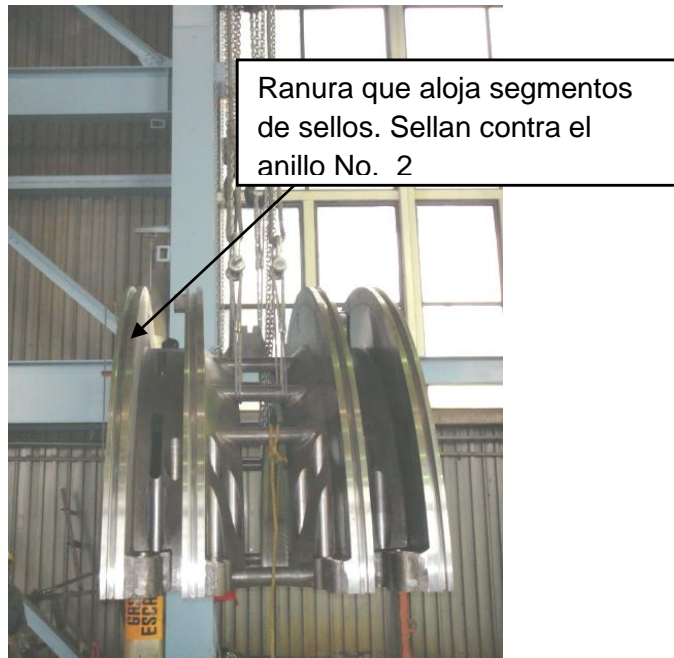
Figura 2.29. Segmento de anillo N.1
