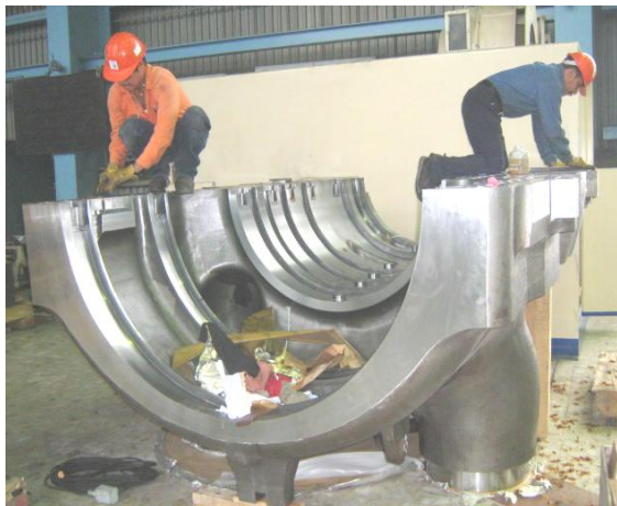
Figura 3.2. Pruebas no destructivas, líquidos penetrantes y partículas magnéticas
