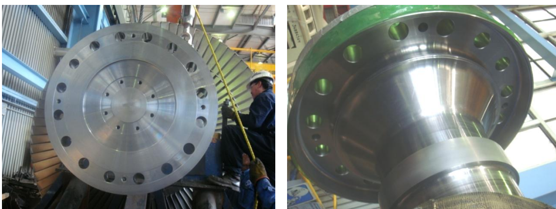
Figura 2.17. Cople del rotor de baja presión lado generador
