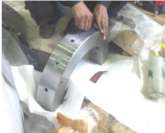
Figura 3.17. Limpieza del anillo superior e inferior utilizando rueda flap
