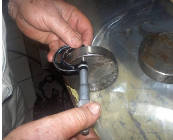
Figura 3.16. Medir espesores de laines de ajuste y marcar. Registrar datos.
