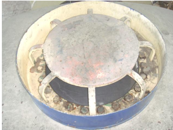
Figura 2.37. Diafragma de plomo montado en su base en periodo de prueba con nivel de agua
