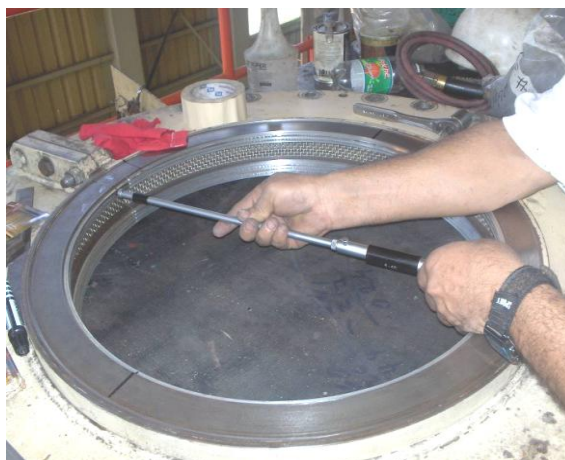
figura 3.12. Medir anillos de deflector
