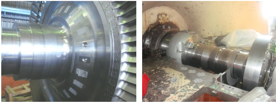
Figura 2.19 Sección de la flecha del rotor donde hace el sello en los extremos. Esta sección es lisa y solo lleva un escalón.
