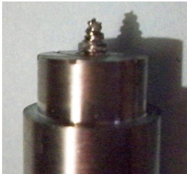
Figura 6.16. Vista frontal próxima de la herramienta donde se aprecia el diseño trífute o de espiral en el perno en forma de V
