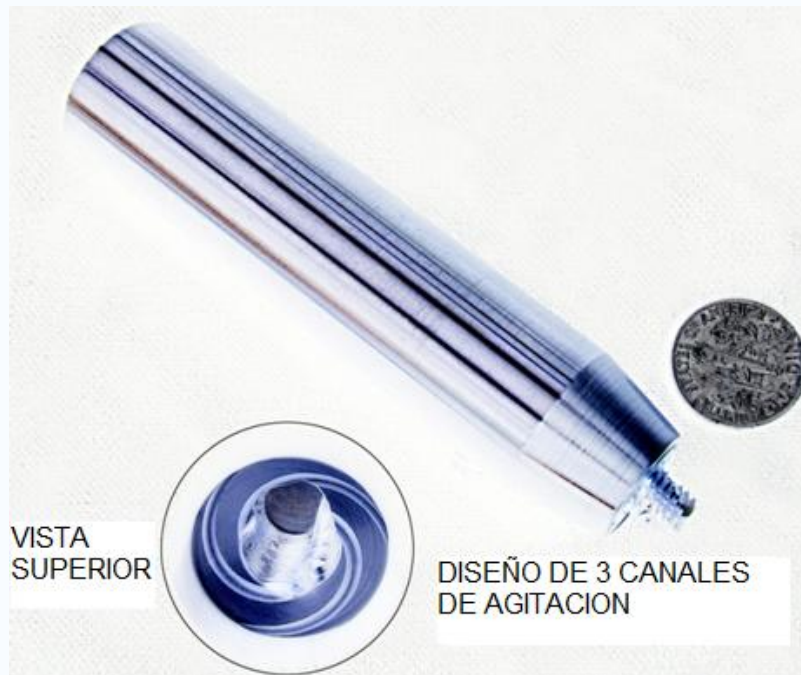
Figura 2.6. Diseño de la herramienta que muestra los canales de agitación que ayudan a mezclar el material en el proceso de soldado
