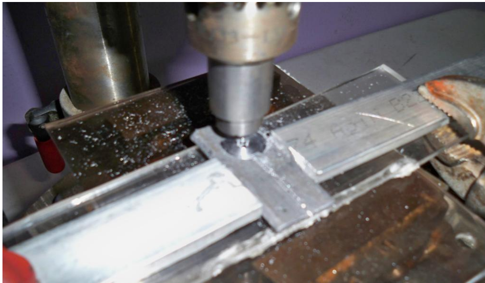
Figura 6.37. Proceso de unión de las placas
