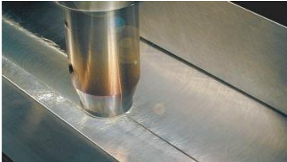
Figura 1.5. Vista próxima de la Herramienta en el proceso de Soldadura por Fricción – Agitación sobre Aluminio
