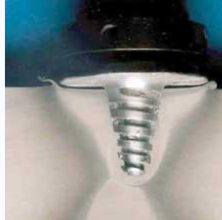
Figura 2.3. Diseño triflute de la herramienta de Soldadura por Fricción - Agitación
