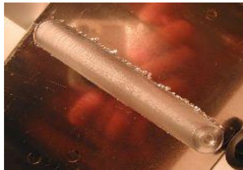
b) El agujero en la parte final es en donde la operación termina
