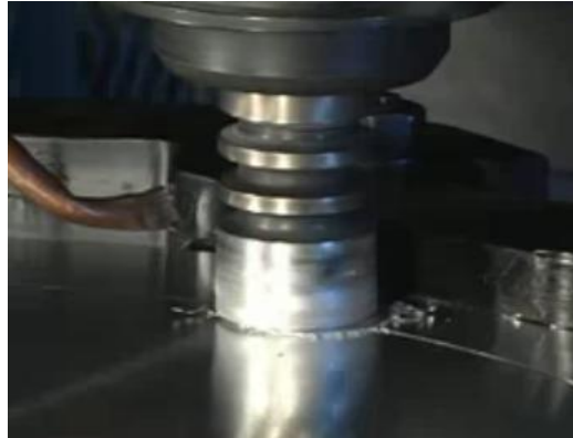
Figura 4.9. Penetración total del PIN e inicio del recorrido
