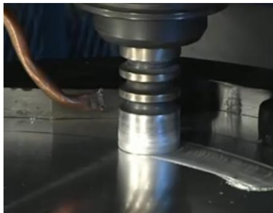
Figura 4.10. Avance que muestra el resultado del Soldado entre las placas
