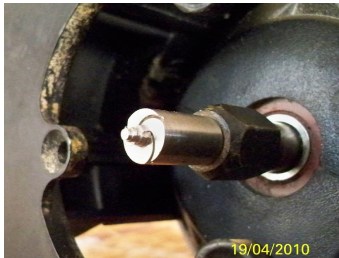
Figura 6.19. Vista lateral superior de la herramienta de FSW acoplada al Router
