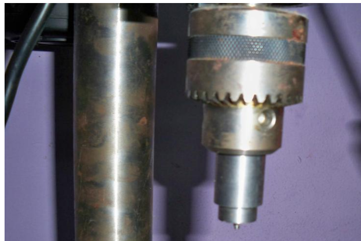
Figura 6.22. Vista proxima de la herramienta acoplada observandose los dos hombros
