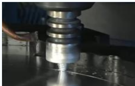
Figura 4.8. Herramienta en Penetración del material para iniciar la unión por Soldadura Fricción - Agitación
