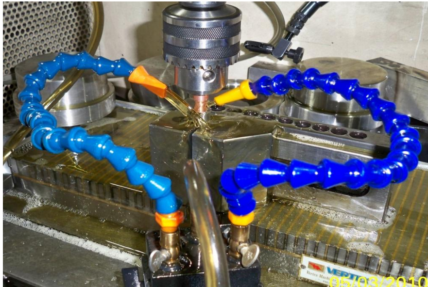
Figura 6.11. Vista proxima de la realizacion de los canales de agitacion
