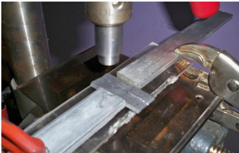
Figura 6.35. Sujeción rigida de las placas vista lateral
