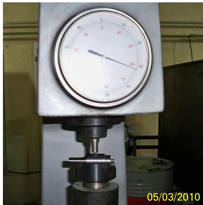
Figura 6.12. Herramienta de FSW sometida a prueba de dureza
