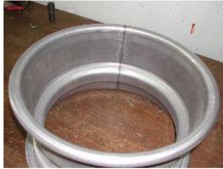
Figura 4.6. Vista interior de una soldadura hecha por Fricción y Agitación en una rueda de aluminio y silicio serie 5000 para un coche deportivo. La FSW se lleva a cabo como un cordón de soldadura en un cilindro, seguido por la operación de conformado.
