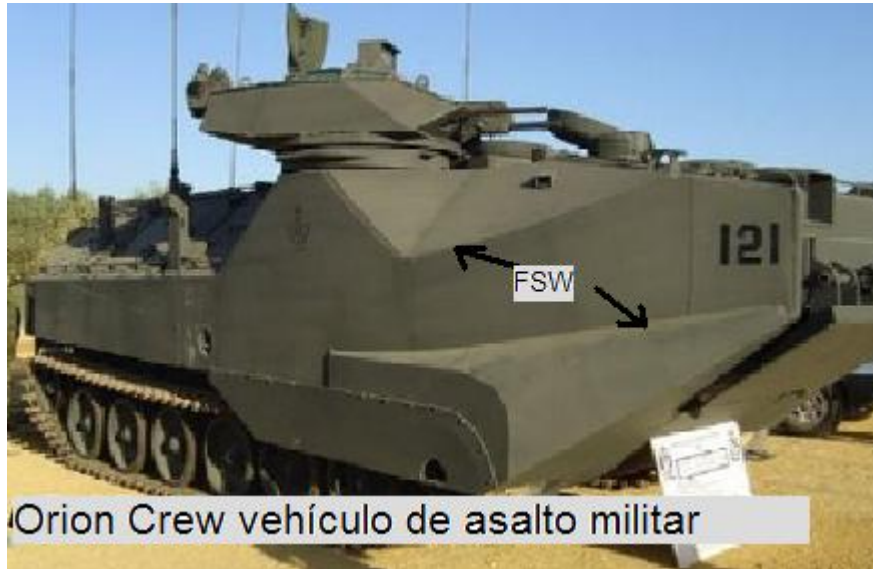
Figura 5.3. En este vehículo se puede apreciar en su diseño donde se uso la Soldadura por Fricción y Agitación, con la Finalidad de soportar los impactos de proyectiles enemigos
