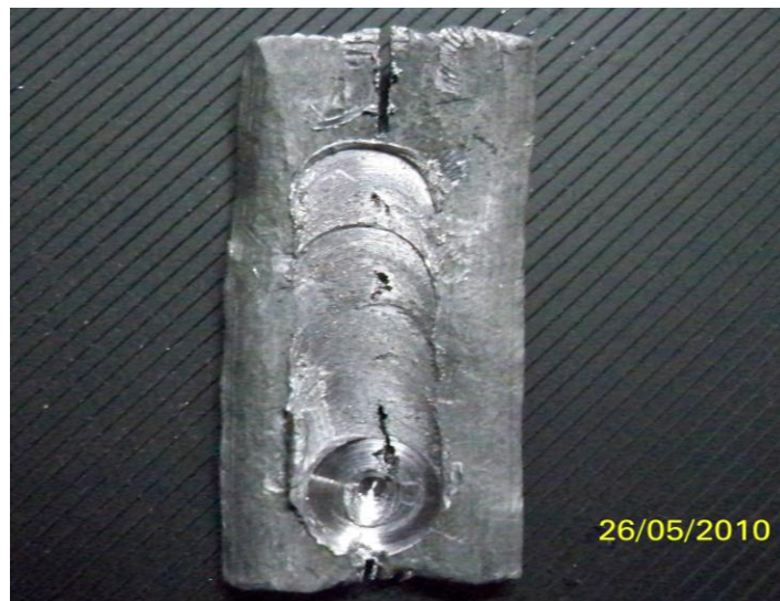
Figura 6.39. placas de plomo soldadas por FSW , se aprecia el orificio de salida de la herramienta
