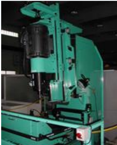
Figura 3.3. Robot utilizado en Pruebas de FSW en magnesio
