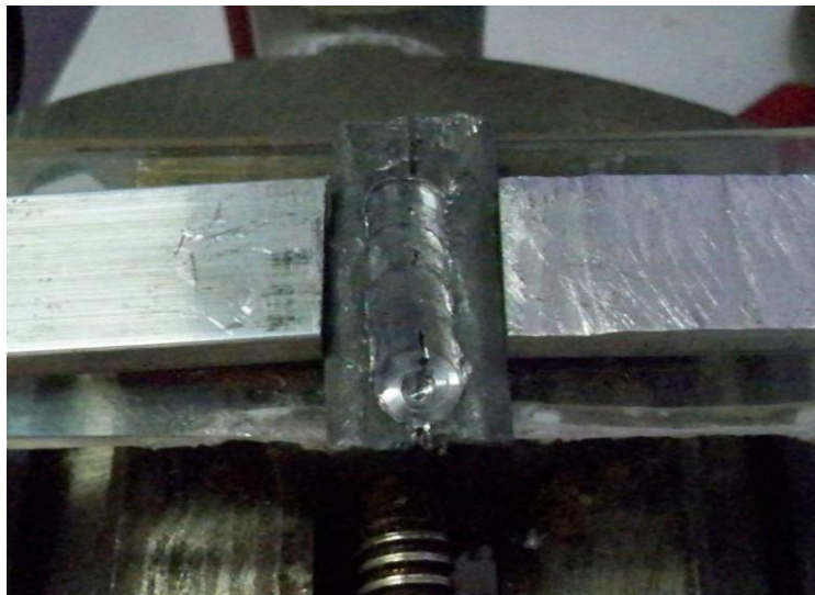
Figura 6.38. vista frontal de la unión de las placas
