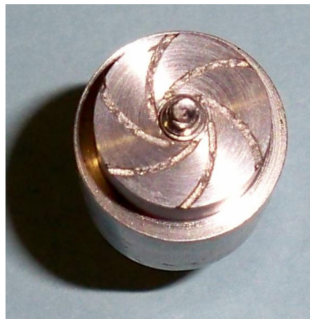
Figura 6.14. Vista superior de la herramienta que muestra los 6 canales de agitación
