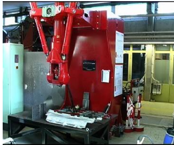
Figura 3.4. Robot con mecanismos eléctricos para soldar aluminio
