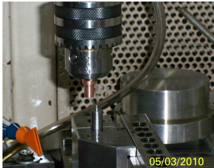
Figura 6.10. Erosionadora acercandose a la herramienta
