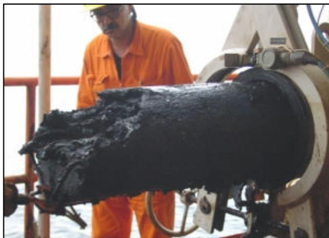
**Figura 1.16. Obstrucción por Presencia de Parafinas y Asfaltenos.**
