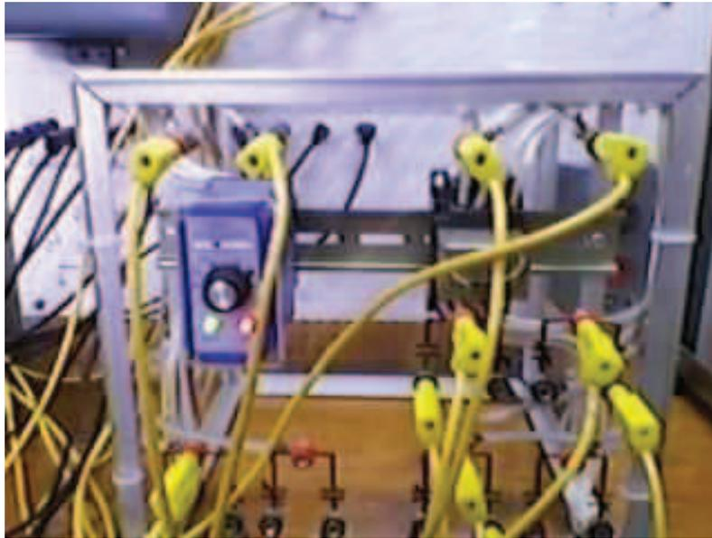
**Fig.6. 37** Temporizador T1 activado después de 10s
