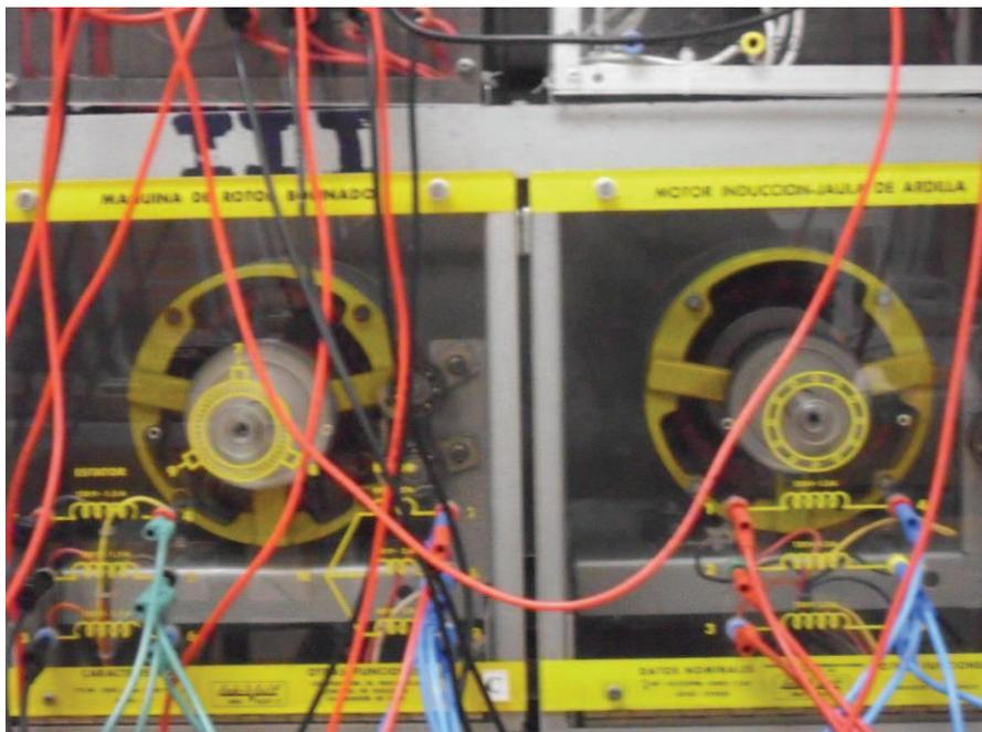
**Fig.2. 28 Motor jaula de ardilla y Motor Bobinado**
