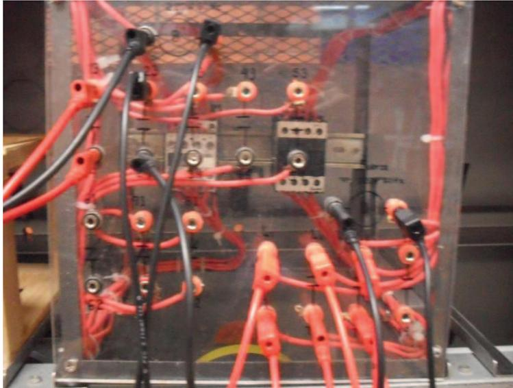
**Fig.1. 82 Modulo de contactores de control y fuerza**
