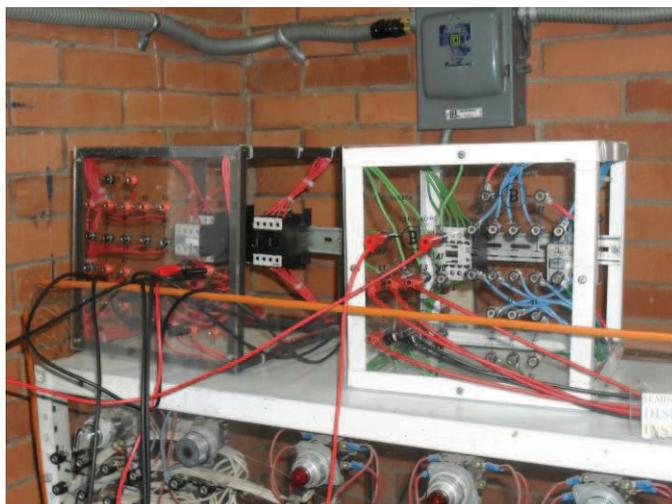
Fig.7. 38 Módulos de contactos de fuerza y control
