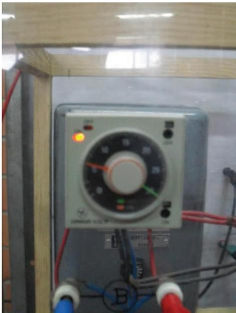
**Fig.7. 48 Tx termina de contar 30s y desconecta**
