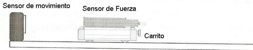
**Figura I.7 instalación para el Experimento de empujar/ jalar**
