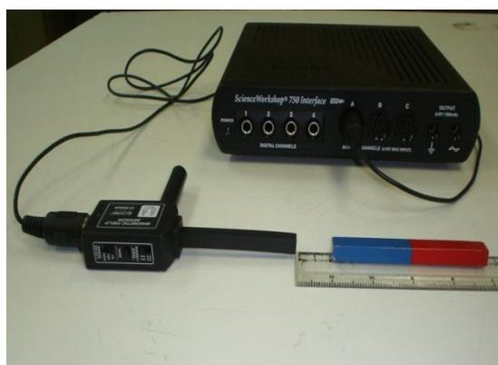
**Figura III.3 Forma de medir campo magnético mediante la interfaz.**
