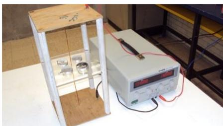
**Figura III.5 Detección del campo magnético por medio de brújulas, producido por una corriente eléctrica que circula por conductor recto.**
