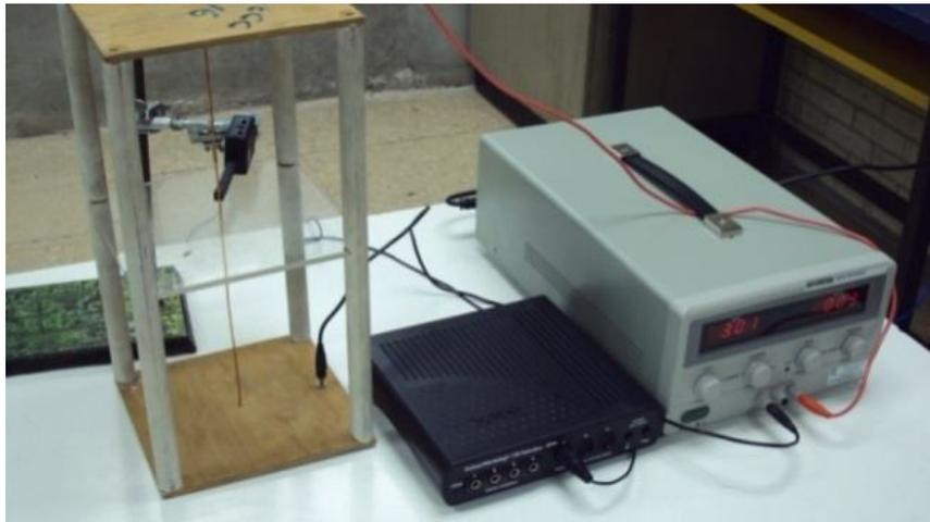
**Figura III.7 Detección del campo magnético por medio de la interfaz producida por una corriente eléctrica que circula por conductor recto.**
