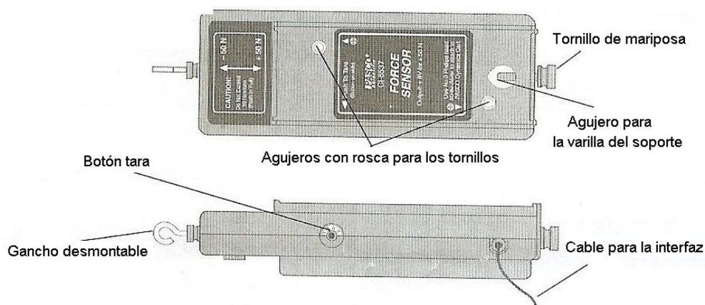
**Figura I.4 Componentes del sensor de fuerza**
