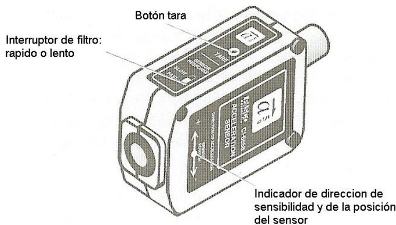
**Figura I.15 Sensor de control de configuración y flecha indicadora del sentido de la sensibilidad.**
