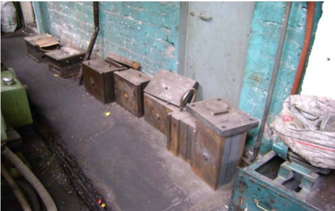
Foto 4.9 Los moldes de las máquinas se encuentran en los pasillos del área de trabajo con los cuales se puede provocar algún daño a un trabajador.
