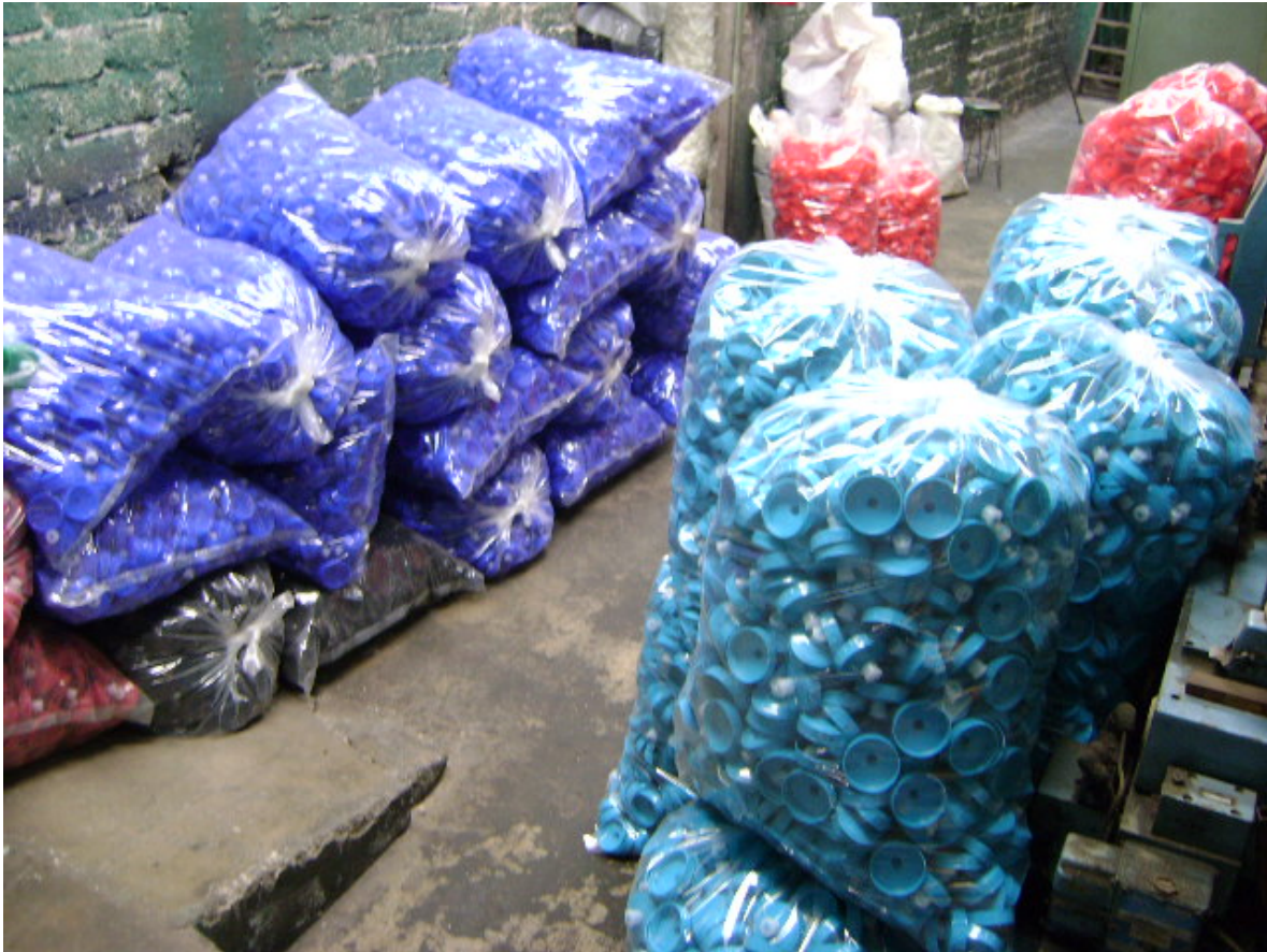
Foto 4.4. El material acumulado en los pasillos obstruye el paso a los trabajadores.
