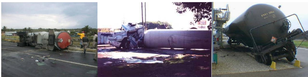
Figura 4.8 Accidentes de unidades de transporte de MPs, tipo volcadura por malas prácticas operacionales del conductor
