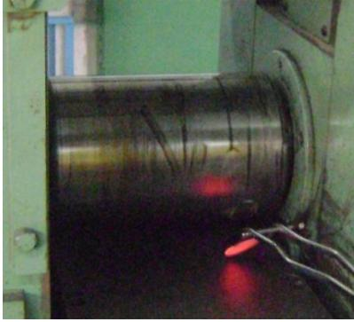
**Figura 3.10.** Muestra calentada a 900°C previa a ser laminada.
