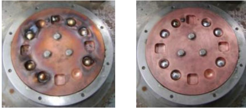
**Figura 3.7.** Muestras obtenidas después de la fusión (izquierda), crisol limpio y muestras giradas para realizar refusión (derecha).
