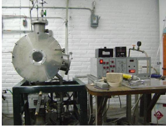
**Figura 3.12.** Equipo de Solidificación rápida por bloque frío.
