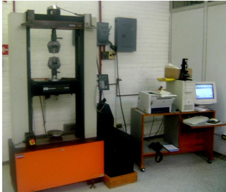
**Figura 3.18.** Máquina de ensayos universales mca. Instron mod. 5500R.
