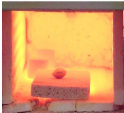
**Figura 3.9.** Muestra colocada en la mufla a 900°C.
