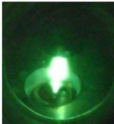
**Figura 3.6.** Arco eléctrico realizando la fusión del material.
