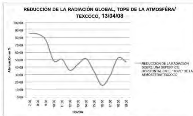
Gráfica: Reducción de la Radiación Global, sobre una superficie horizontal en el "tope" de la atmósfera y en la estación de Texcoco el día 13 de abril de 2008
