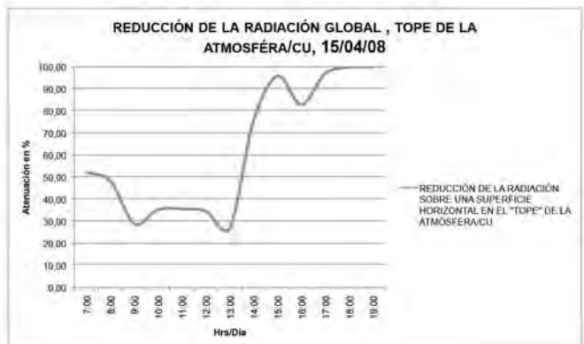
Gráfica: Reducción de la Radiación Global, sobre una superficie horizontal en el "tope" de la atmósfera y en la estación de Ciudad Universitaria el día 15 de abril de 2008
