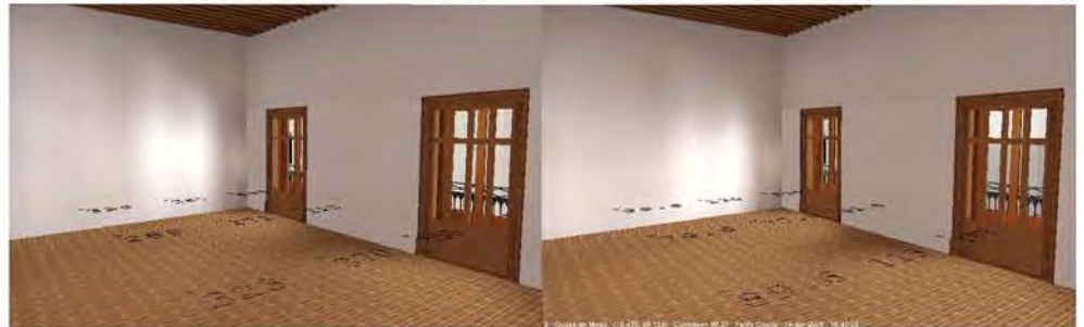
Imágenes: Simulación en computadora, RGB, iluminancia de las 8:33 a las 16:33, cada dos horas
