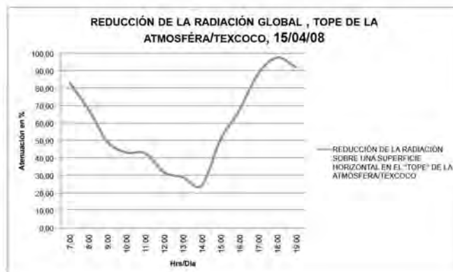
Gráfica: Reducción de la Radiación Global, sobre una superficie horizontal en el "tope" de la atmósfera y en la estación de Texcoco el día 15 de abril de 200
