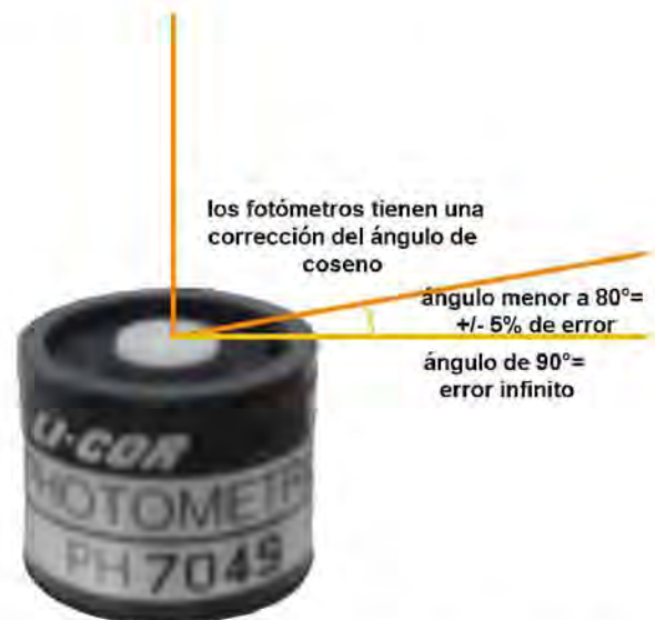
Fotómetro de la LI-COR LI-210SA marca Li-Cor, corrección del ángulo del coseno
