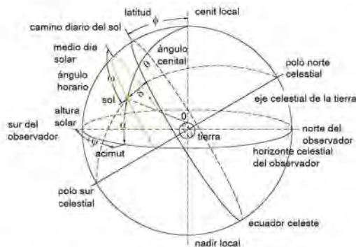
Las Coordenadas Locales y las Coordenadas Geocéntricas del Sol con origen común en la Tierra (Muhlia, 06, dibujado por la autora de esta tesis)
