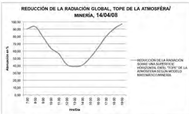
Gráfica: Reducción de la Radiación Global, sobre una superficie horizontal en el "tope" de la atmósfera y en la estación de Minería el día 14 de abril de 2008
