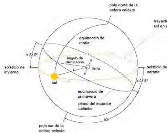
El movimiento aparente del Sol en la esfera celeste y el ángulo de Declinación de la línea Sol-Tierra respecto del plano de la elíptica (Muhlia, 06, dibujado por la autora de esta tesis)
