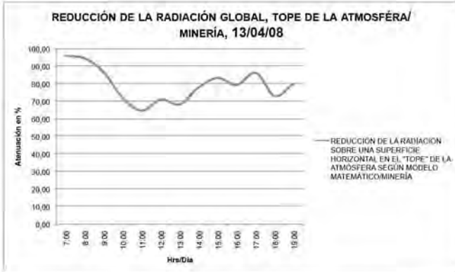
Gráfica: Reducción de la Radiación Global, sobre una superficie horizontal en el "tope" de la atmósfera y en la estación de Minería el día 13 de abril de 2008
