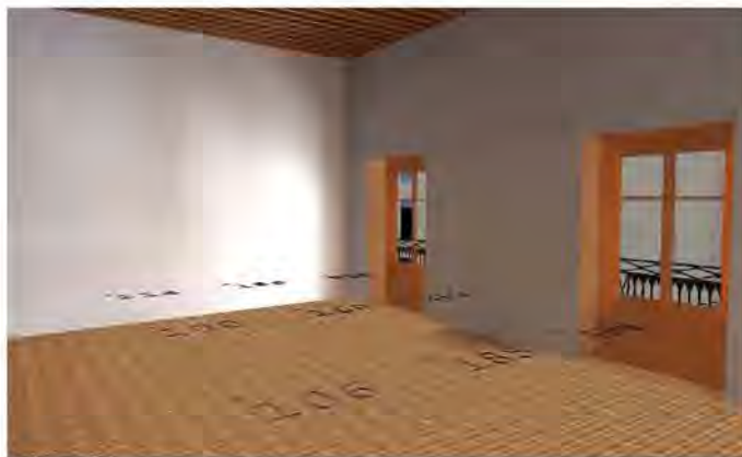
imagen: Simulación en computadora, RGB, iluminancia de las 14:33 horas, espacio real con 6.7% de ventanas
