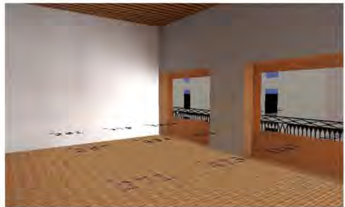
imagen: Simulación en computadora, RGB, iluminancia de las 14:33 horas, espacio con 17.5% de ventanas, según el reglamento
