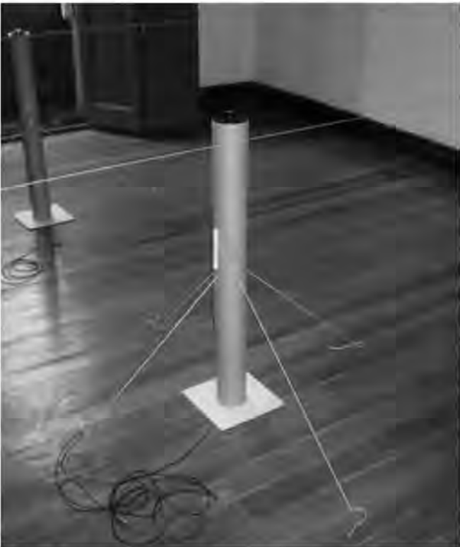
Fotografía del montaje de los fotómetros en interior del espacio real, salón principal
