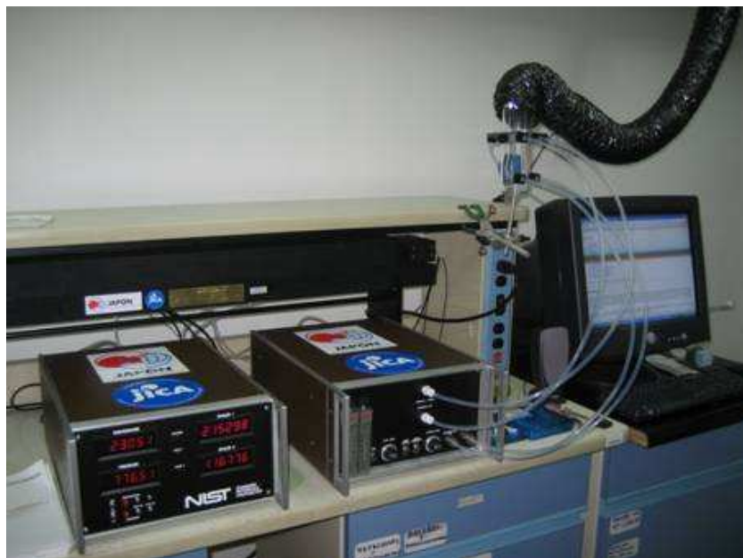
Figura 12. Fotómetro estándar de referencia del laboratorio de calibraciones del CENICA Tecamachalco.
