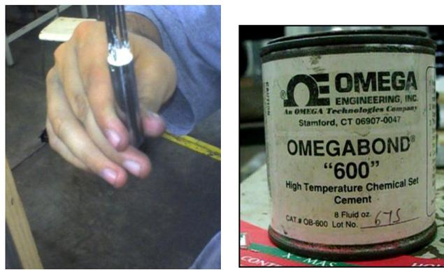
Figura 3.11. Instrumentación de la probeta metálica con termopares y protección de barrenos con cemento marca, modelo OMEGABOND 600, utilizado para evitar que se infiltre agua.
