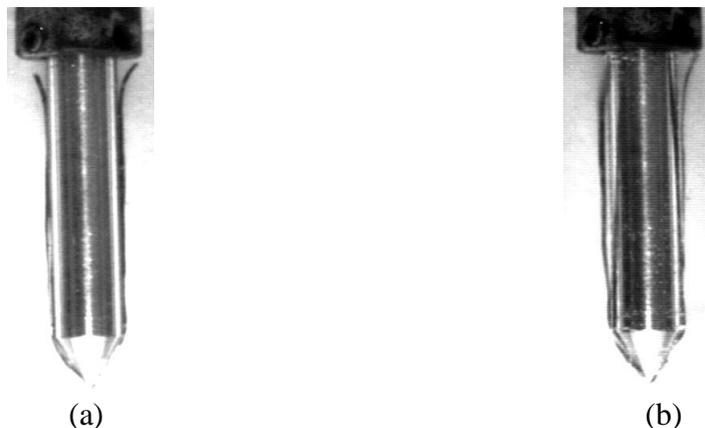
Figura 4.38. Imágenes de listones sujetos a la base de las probetas cilíndricas de punta cónica para agua circulando, en un ducto de  $44.4\text{ mm}$  de diámetro interno, a una velocidad de: a)  $0.20\text{ m/s}$  y b)  $0.60\text{ m/s}$ .
