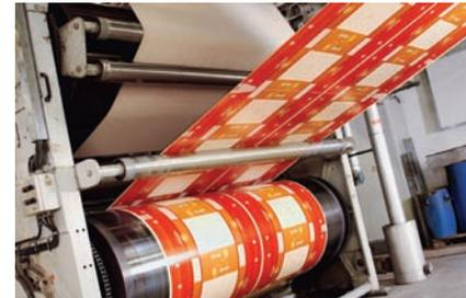
Fig. 38. Impresión flexográfica
