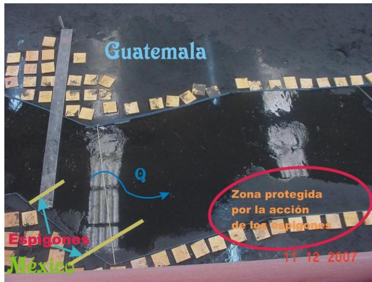
**Fig. 3.7 Espigones funcionando del lado Mexicano**
