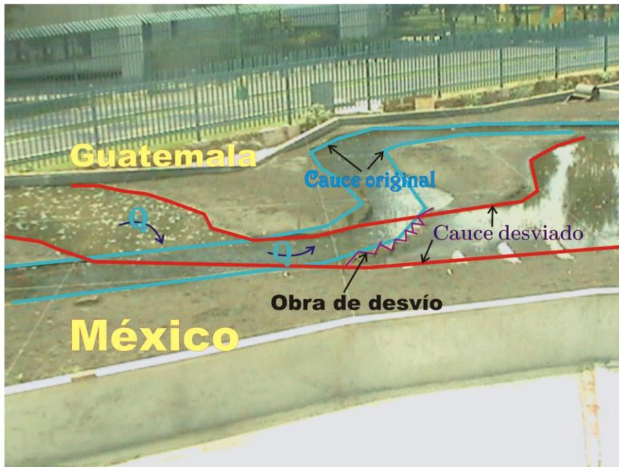
Fig. 3.12 Modelo del río Suchiate en el tramo del Corte Ponciano.
