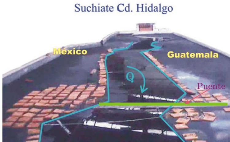
**Fig. 3.4 Pruebas realizadas con gastos de distintas magnitudes para entender mejor el fenómeno, vista aguas debajo de Ciudad Hidalgo.**
