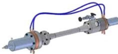
**Figura 4.1.** Refrigerador termoacústico.
