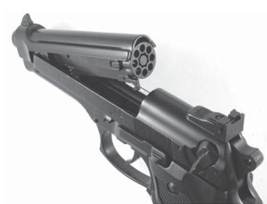
Figura 4.10: Revólver con clip rotatoria de 8 tiros.
