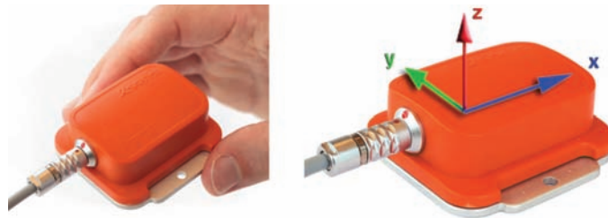
Figura 6.1: Unidad de medición inercial Xsens-MTi y su sistema coordenado local.
