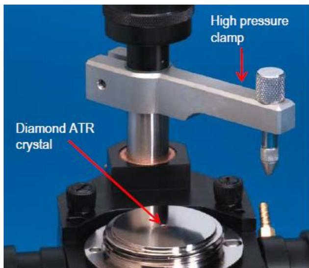
**Figura 4.11.** Accesorio ATR MIRacle<sup>®</sup> configurado con una prensa de alta presión para obtener un mayor contacto entre la muestra y el cristal ATR de diamante.
