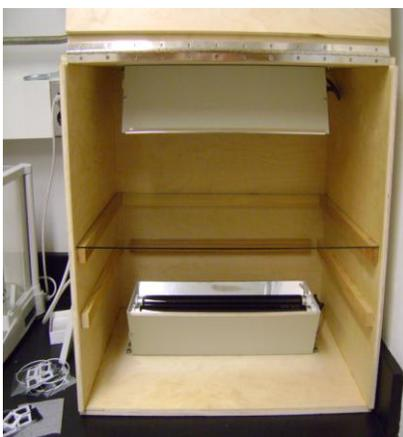
**Figura 5.2.** Cámara de fotocurado con lámparas de luz ultravioleta a 5 cm de distancia de la base de cristal en donde se colocan los viales con disolución a fotocurar.
